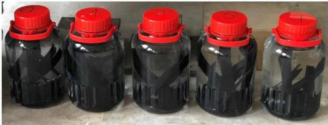
Şekil 3.15. Tuzlu su ortamında bekletilen kompozit test numuneleri
