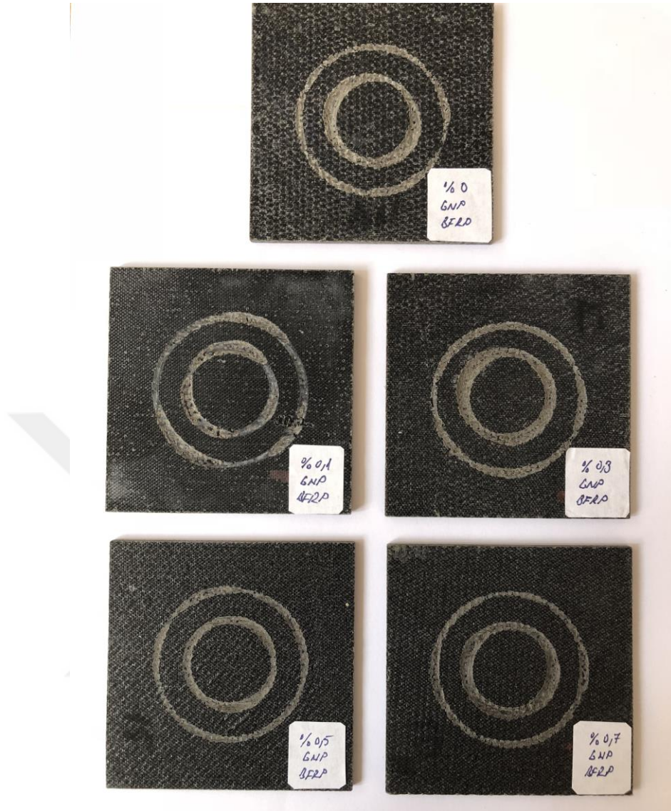
Şekil 4.18. Aşınma testi sonrası katkısız ve GNP katkılı kompozit test numuneleri
