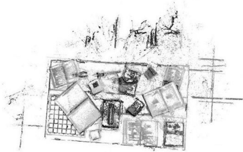
Şekil 4.29. Görsel SLAM tekniklerinin kullanıldığı çalışmaya dair ORB-SLAM yöntemi temel alınarak geliştirilen yöntem sonucu elde edilen derinlik haritası, uzak görünüm
