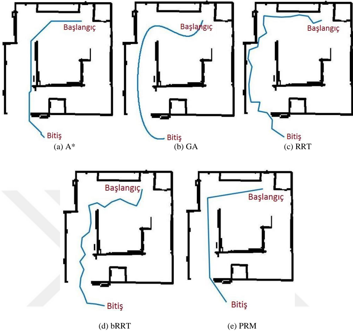
Şekil 4.8. En uygun yol bulma problemi çalışması için farklı algoritmalara dair başlangıç ve bitiş noktaları arası elde edilen yollara ait eğriler; (a) A*, (b) GA, (c) RRT, (d) bRRT, (e) PRM
