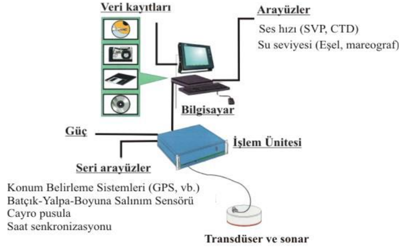
Şekil 3.17. Çok bimli (multibeam) iskandil sistemi ve arayüzleri (Aykut, 2009)
