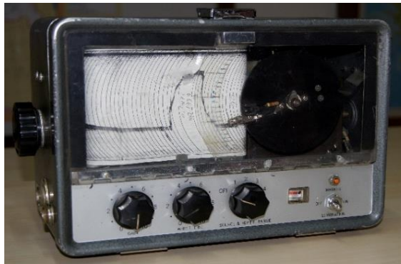
Şekil 5.2. Fruno marka echosounder (DSİ Harita Şube Müd., 2019)
