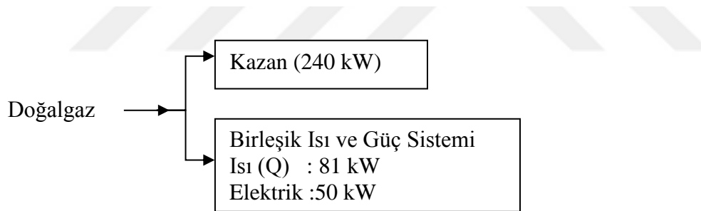
Çizelge 4.34. Birleşik ısı ve güç sistemi (BIG)’ın teknik özellikleri
