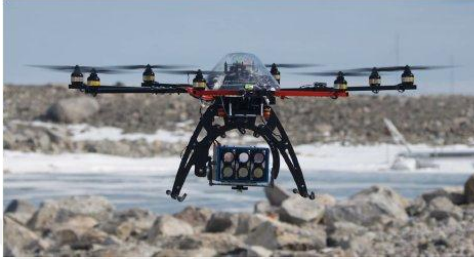
Şekil 2.14. Oktokopter döner kanatlı mikro-İHA'ya monte edilmiş 6 bantlı multispektral sensörler (Lucieer ve ark., 2012)
