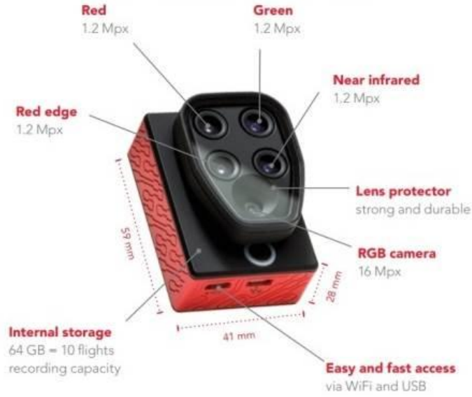
Şekil 2.11. İnsansız Hava Aracı platformlarında kullanılan bir multispektral kamera – Parrot Sequoia
