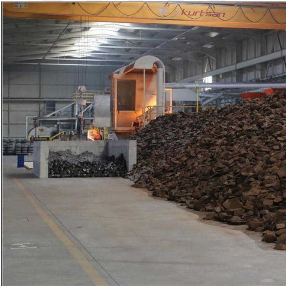
Şekil 4.1 İndüksiyon ocağına şarj yüklemesi
