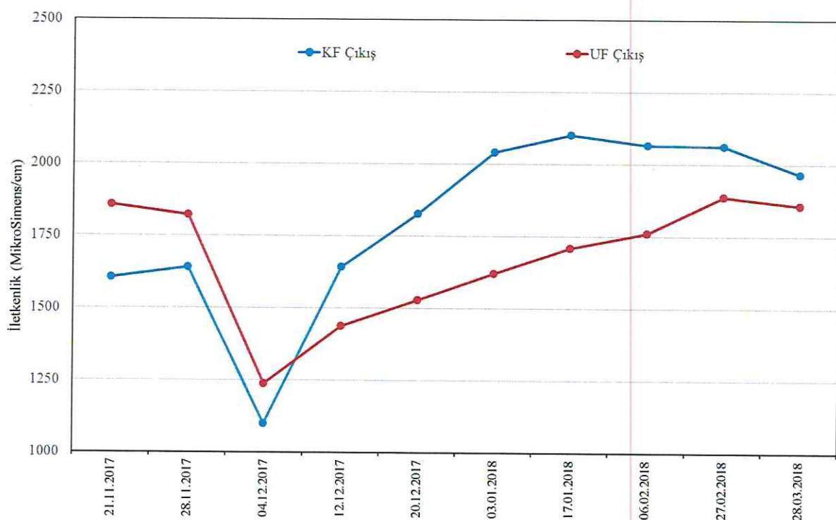
**Şekil 4.13.**UF sistemi giriş çıkış iletkenlik analiz sonuçları
