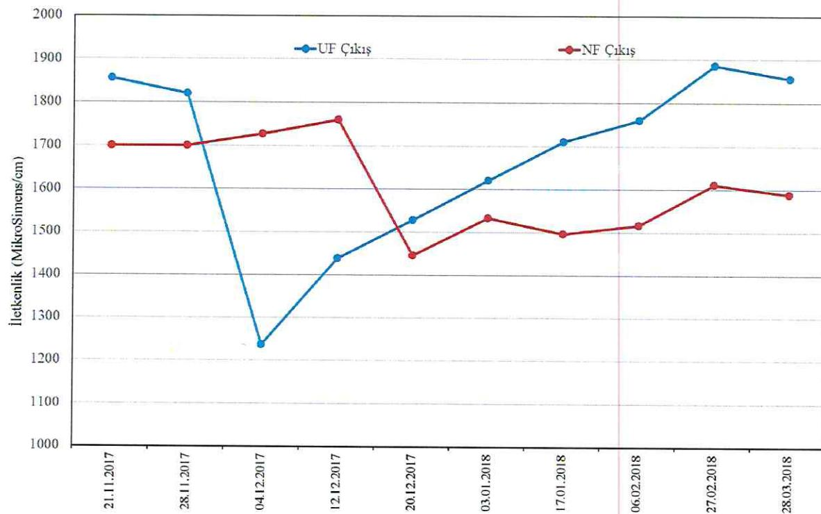
Şekil 4.17.NF sistemi giriş çıkış iletkenlik analiz sonuçları
