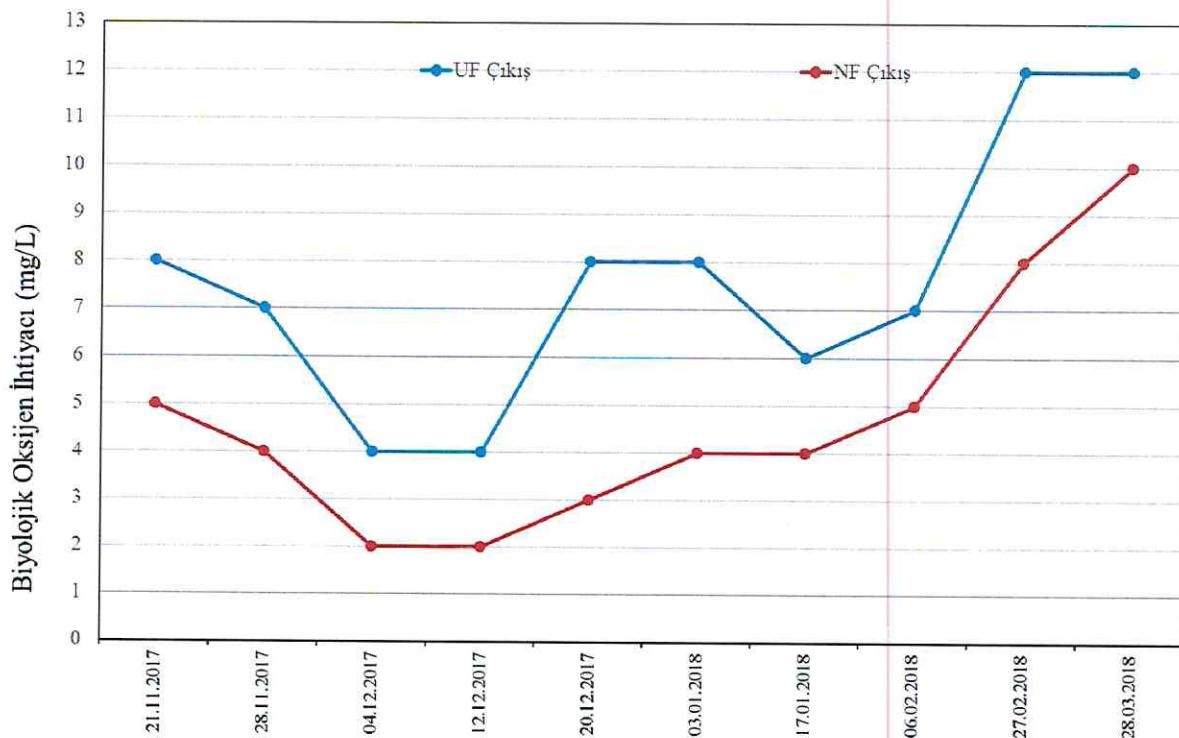
Şekil 4.16.NF sistemi giriş çıkış BOİ<sub>5</sub> analiz sonuçları
