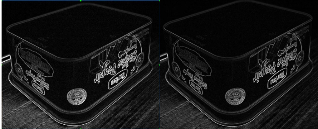
Şekil:6.66. Sobel (solda) ve prewitt (sağda) filtrelerin ürün üzerinde uygulanması
