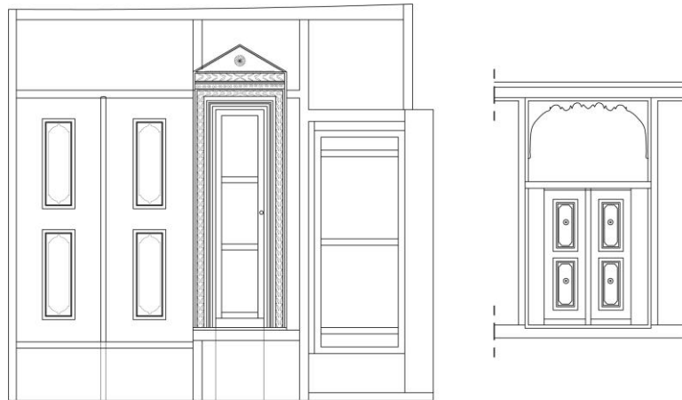
Şekil 4.6.51. Oda 103 yüklük, aynalık, gusülhane ve dolap
