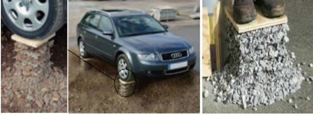
Şekil 3.45 Geogridlerin kenetlenme mekanizmasının işleyişine örnekler
