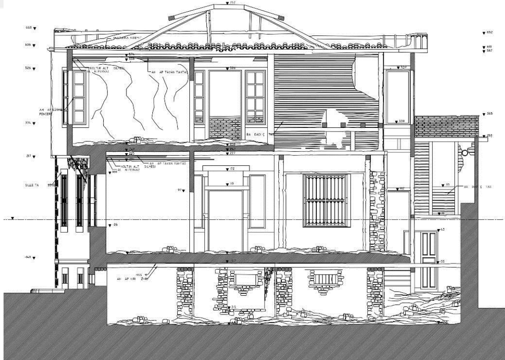
Şekil 5.6.3.2. Yapının I-I kesiti rölöve projesi (Kültür İnşaat)
