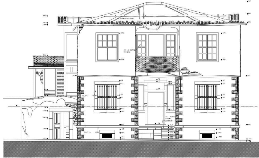
Şekil 5.6.4.1. Yapının batı cephesi rölöve projesi (Kültür İnşaat)
