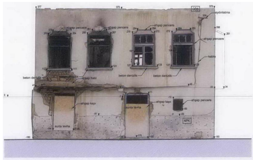
Şekil 5.7.4.1. Yapının batı cephesi rölöve projesi (CRY Mimarlık)
