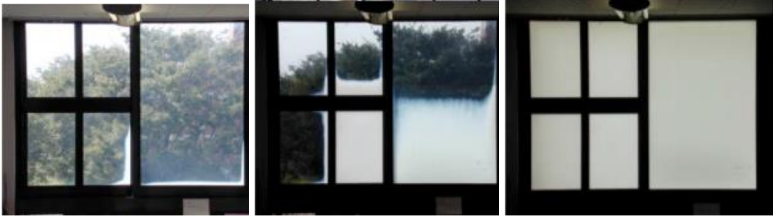
Şekil 2.14. Elektrokromik cam davranışı (Kazanasmaz ve Diler, 2018)
