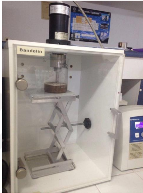
Şekil 3.5. Ultrasonik ses dalgaları veren Sonifikasyon cihazına yerleştirilmiş zeytin karasuyu numunesi
