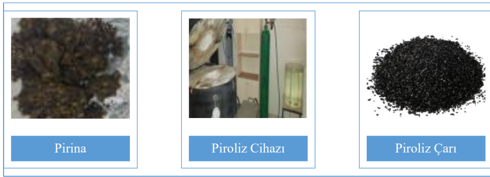
Şekil 3.6. Ham Pirina-Piriliz Cihazı ve elde edilen piriliz çarı
