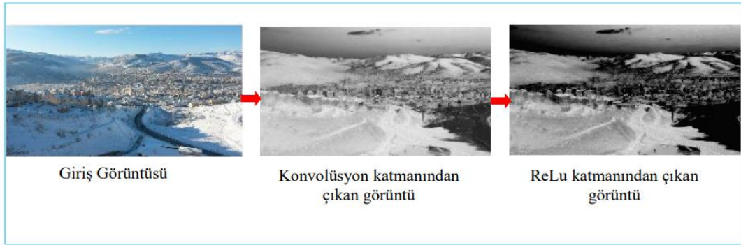
Şekil 3.24. Bir ESA modelinde evrişim katmanı ve ReLU katmanının giriş görüntüsüne yapmış olduğu etki (Özkan ve Ülker, 2017)
