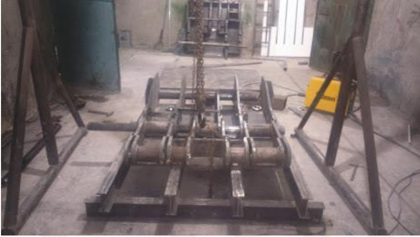
Şekil 3.14. İlk Tahkimatın İmalatı
