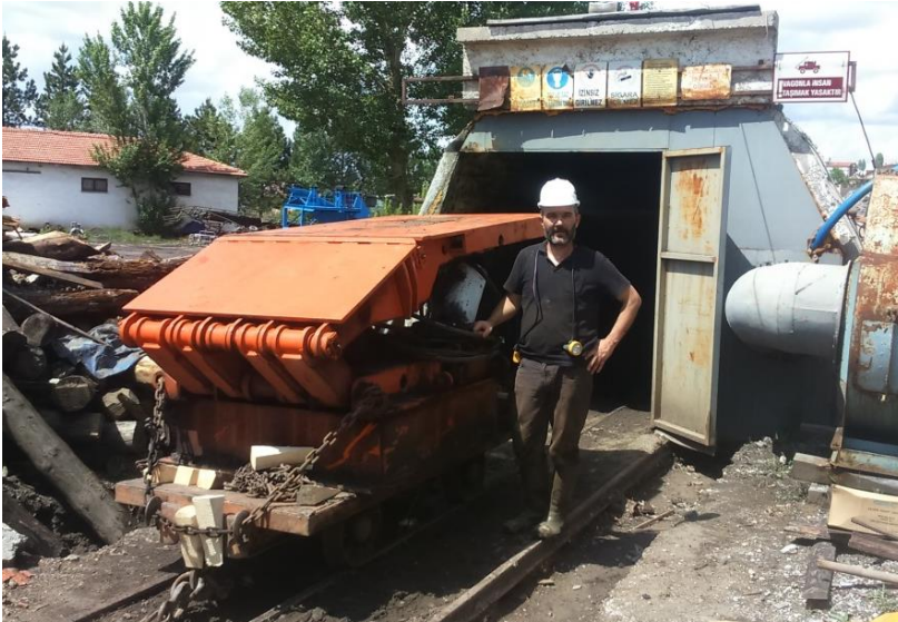
Şekil 3. 25. Yürüyen Tahkimatların Ocak İçerisine Taşınması
