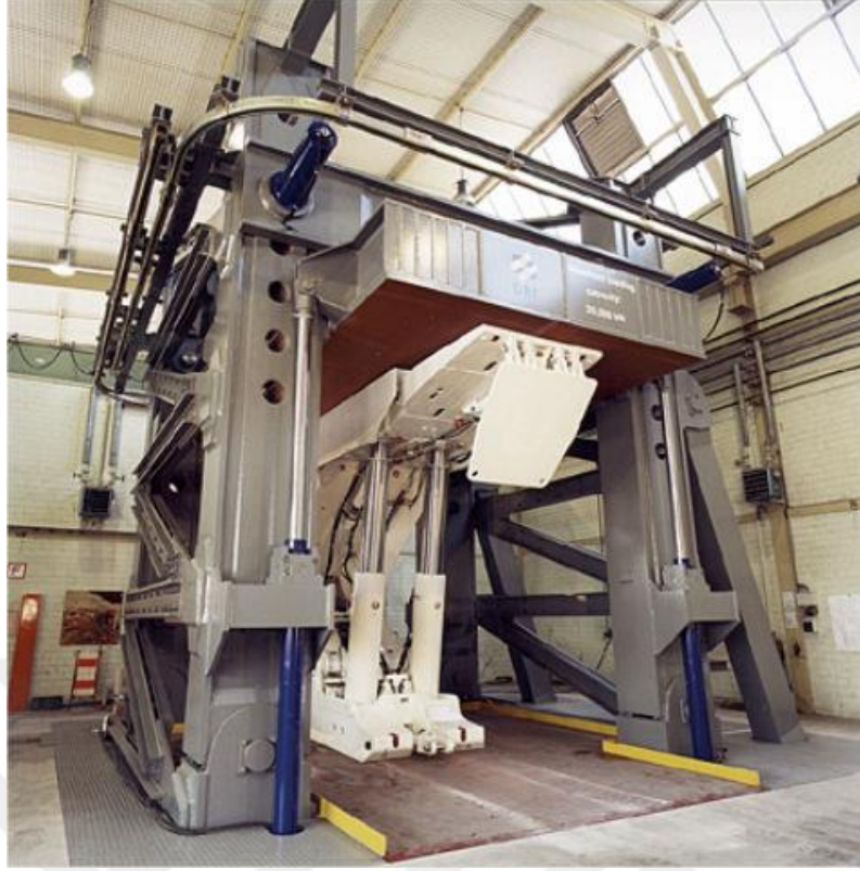
Şekil 2.32. Tahkimatların Test Edilmesi
