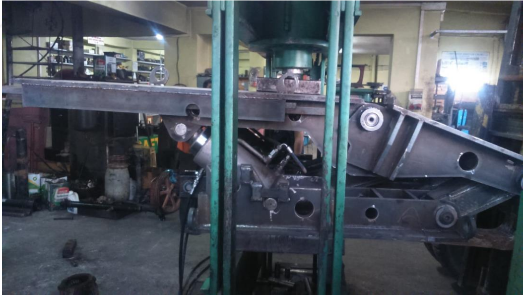
Şekil 3. 13. Tahkimatların 250 Tonluk Pres Altında Test edilmesi
