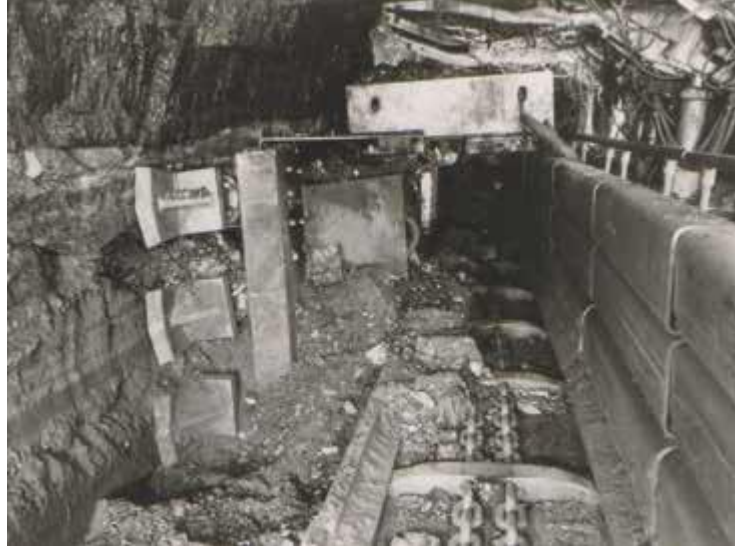
Şekil 2.5. Makinenin her iki tarafındaki hidrolik kazııcı uçlar vasıtasıyla aktarılan ve pulluk zinciri tarafından çekilen sistem (Cat.com,2019)
