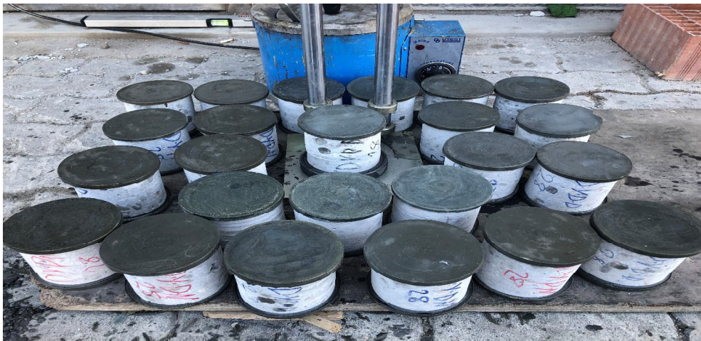
Şekil 4.10. Çalışma kapsamında alınan karot numunelerinin başlıklama işlemi
