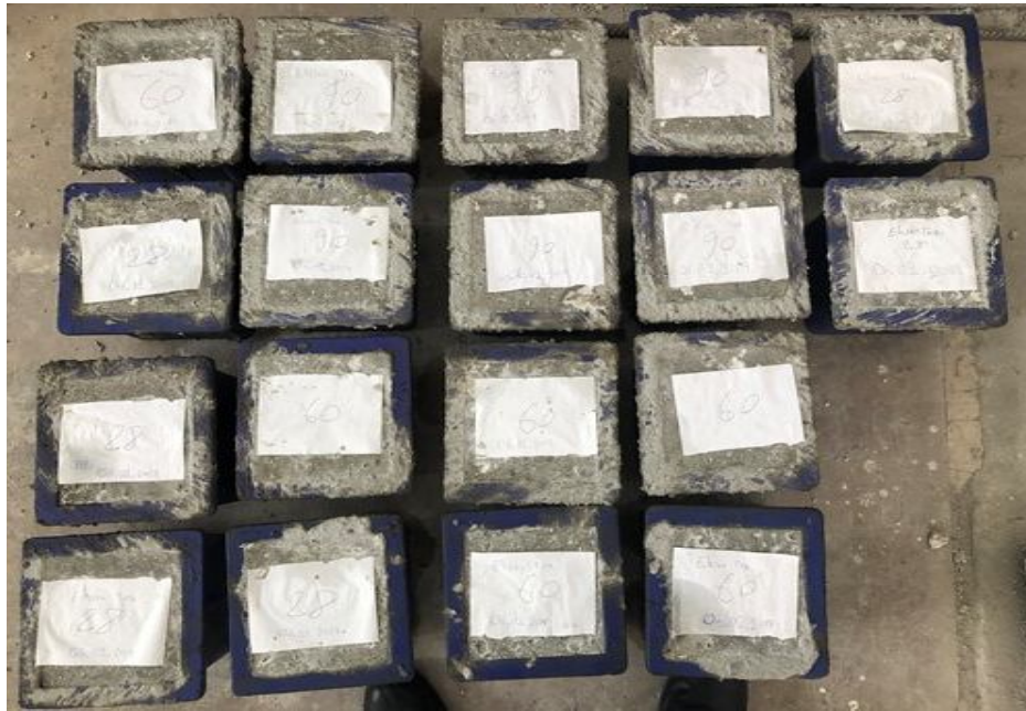
Şekil 3.11. Standart küp numunelerin alınması
