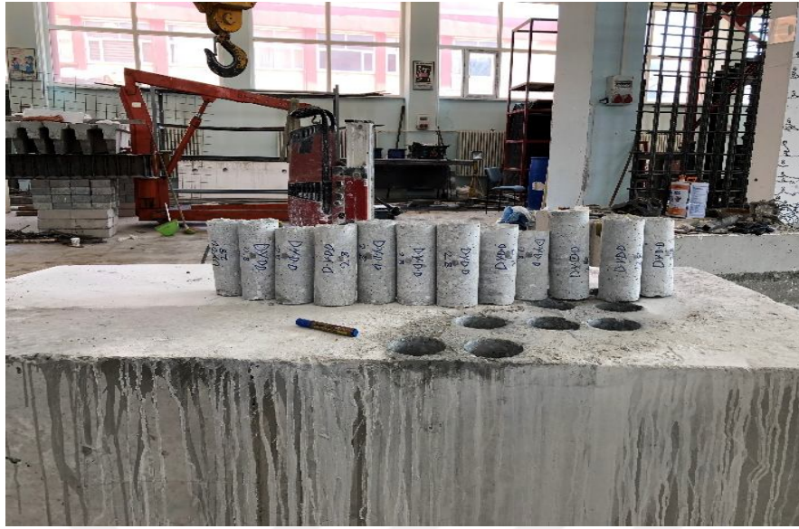
Şekil 4.3. Farklı yönlere göre 28 günlük donatılı karot numunelerinin alınması
