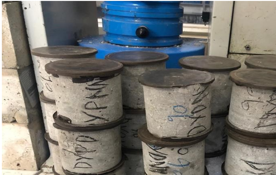
Şekil 4.13. çalışma kapsamında alınan karot numunelerinin 90 günlük basınç deneyi
