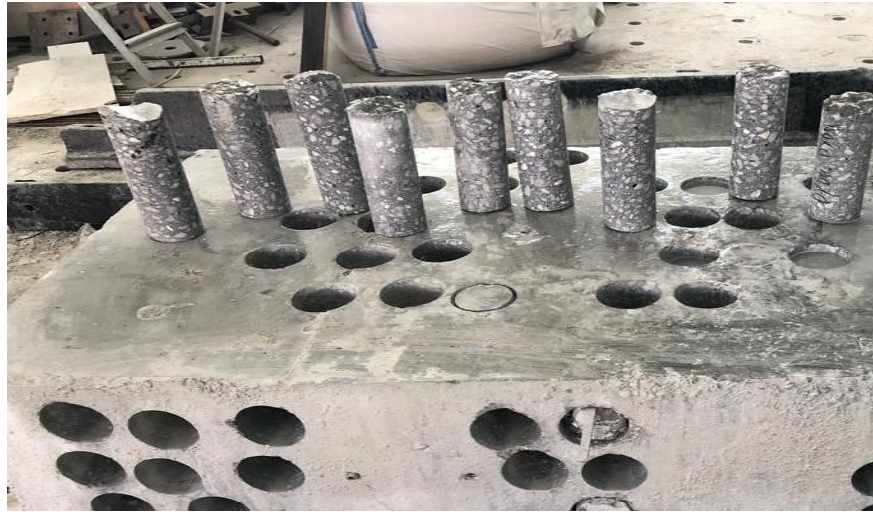
Şekil 4.7. Farklı yönlerde 90 günlük donatılı karot numunelerinin alınması
