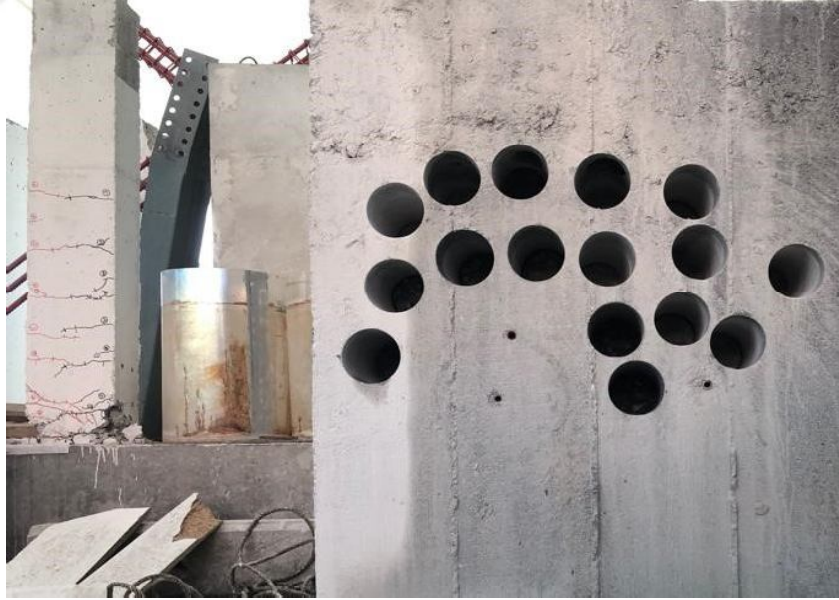
Şekil 4.6. Farklı yönlere göre 90 günlük donatısız karot numunelerinin alınması
