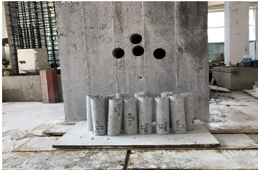
Şekil 4.2. Farklı yönlere göre 28 günlük donatısız karot numunelerinin alınması
