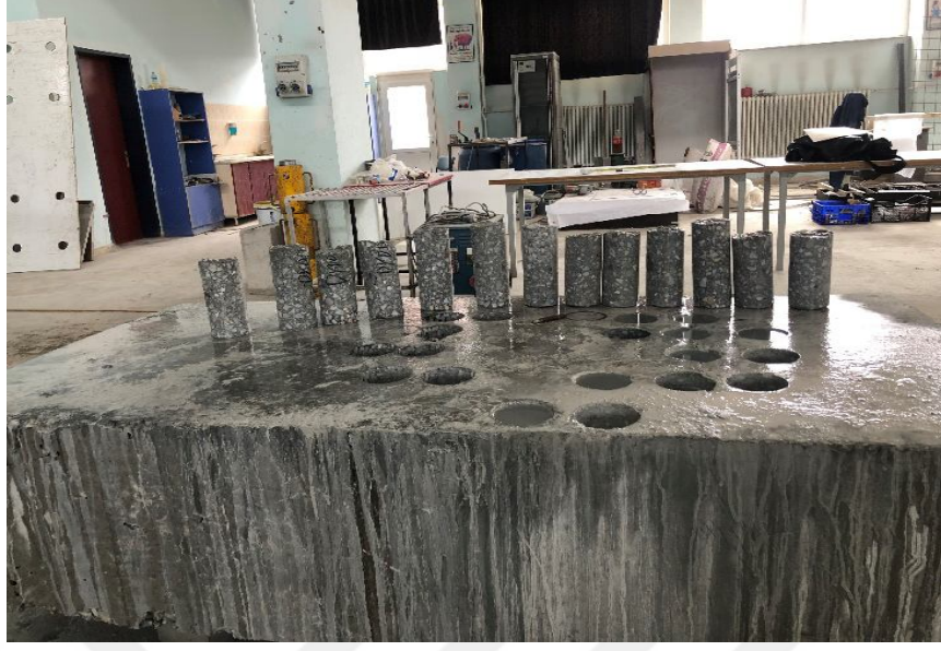
Şekil 4.5. Farklı yönlere göre 60 günlük donatılı karot numunelerinin alınması
