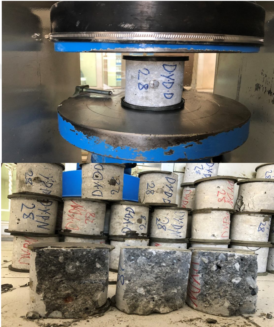
Şekil 4.11. Çalışma kapsamında alınan karot numunelerinin 28 günlük basınç deneyi
