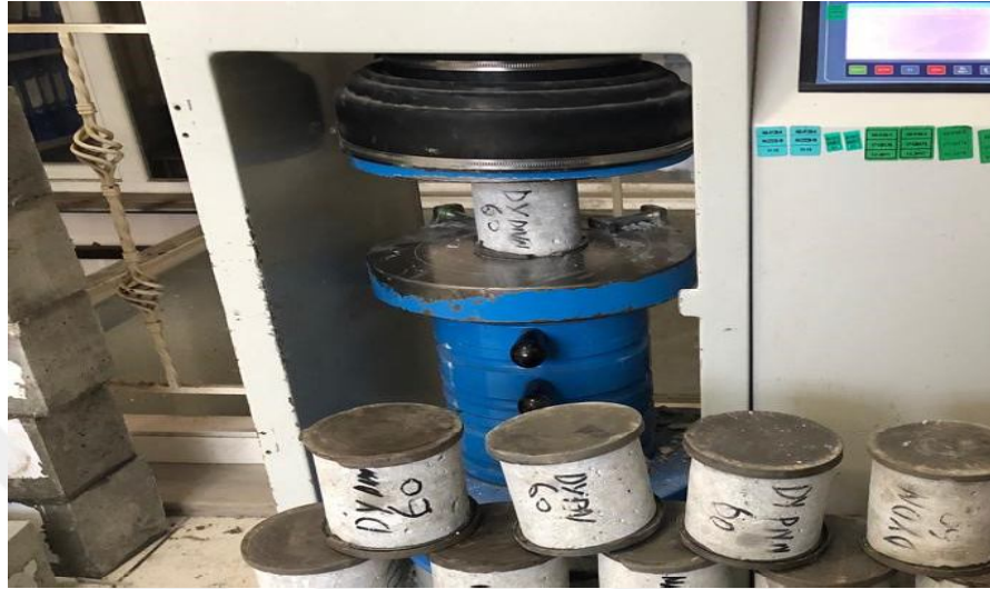
Şekil 4.12. Çalışma kapsamında alınan karot numunelerinin 60 günlük basınç deneyi
