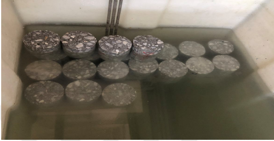
Sekil 4.9. Çalışma kapsamında alınan karot numunelerinin kesim işleminden sonra suda kür edilmesi
