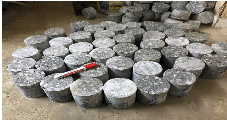
Şekil 4.8. Çalışma kapsamında alınan karot numunelerinin kesim işlemi
