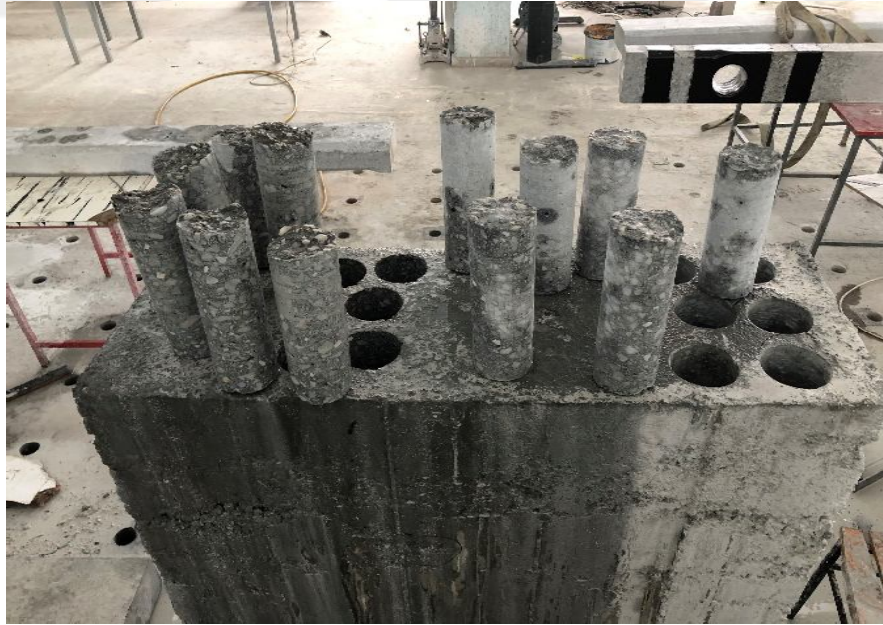
Şekil 4.4. Farklı yönlere göre 60 günlük donatısız karot numunelerinin alınması
