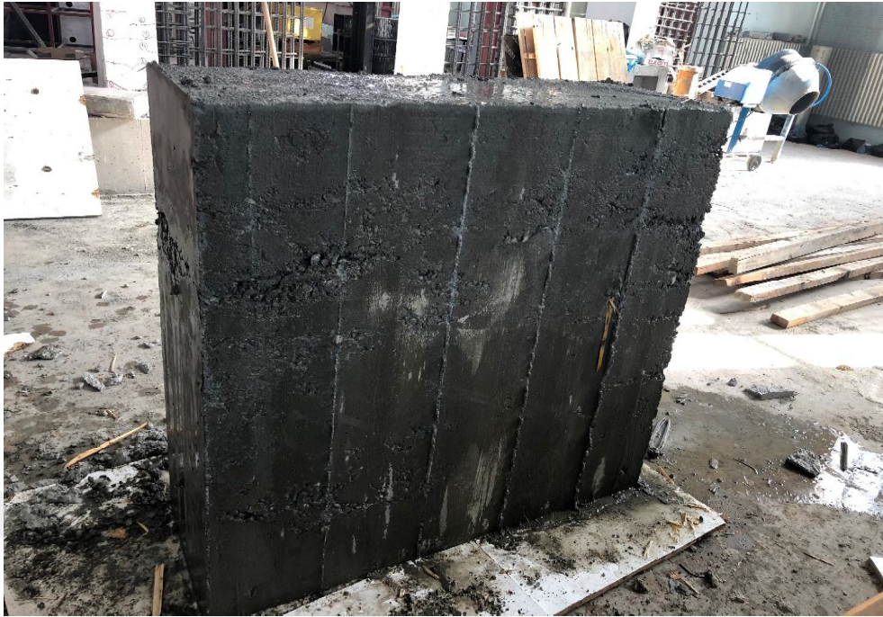
Şekil 3.14. normal karot numunelerinin alınması için üretilen salt beton blok
