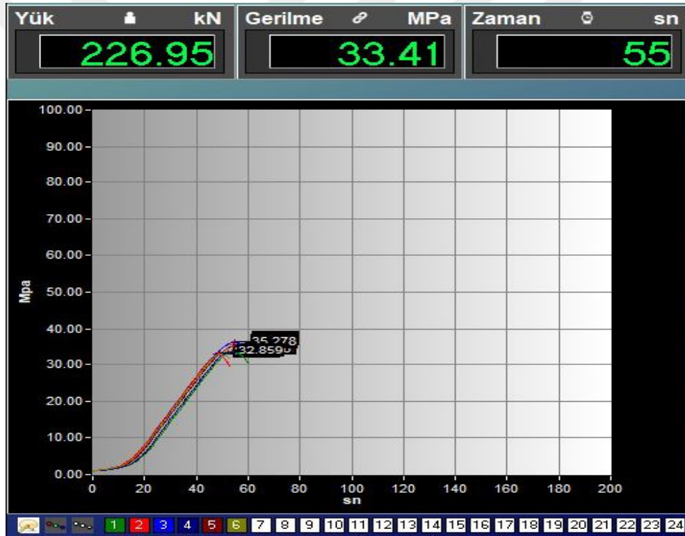
Şekil 4.14. 28 günlük karot numunesinin kırım makinesindeki basınç deneyi şekli
