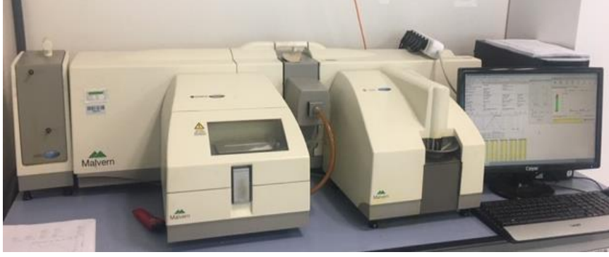
Şekil 3.3. Malvern partikül büyüklüğü ölçüm cihazı
