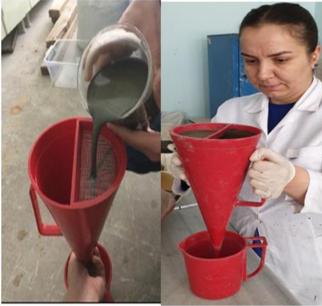
Şekil 3.12. Marsh hunisi deneyinin yapılışı
