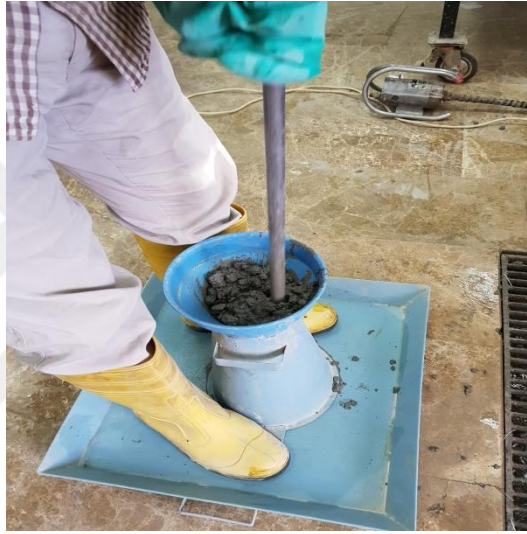
Şekil 4.6. Slump deneyi esnasında alınan bir görüntü
