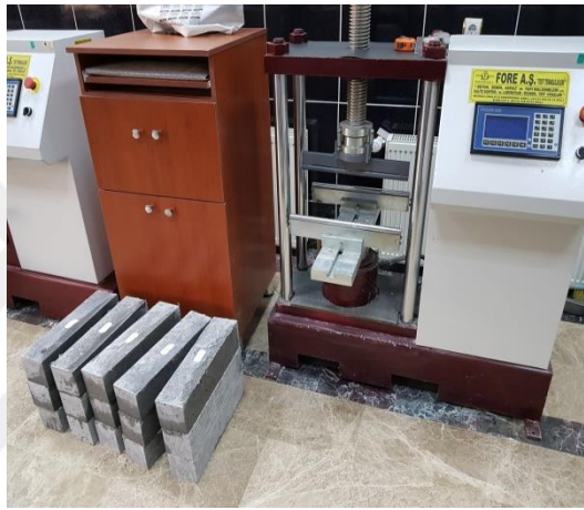
Şekil 4.9. Eğilme dayanım tayini deneylerinde kullanılan hidrolik pres
