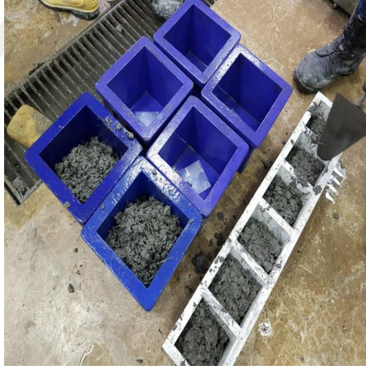
Şekil 4.2. Beton karışımlarından numune alınması
