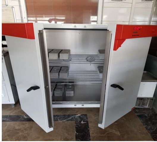
Şekil 4.7. Su emme tayini için numunelerin sabit kütleye gelinceye kadar kurutulduğu etüv
