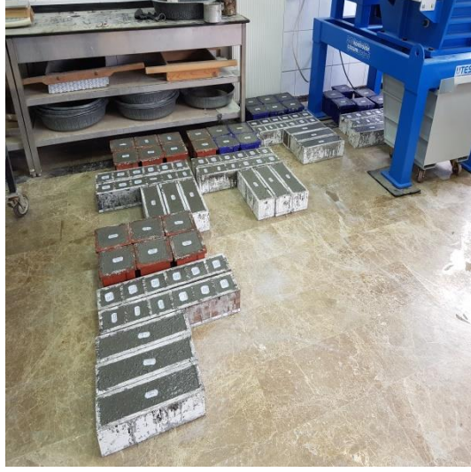
Şekil 4.3. Beton karışımlarından alınan deney numunelerinin genel bir görüntüsü
