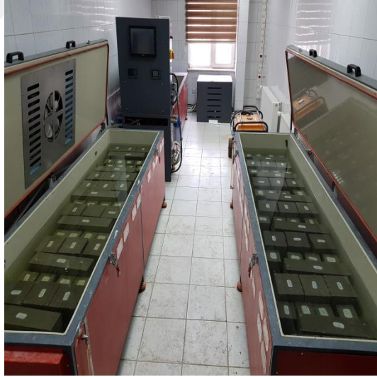
Şekil 4.4. Beton numunelerinin kür havuzundaki görüntüsü
