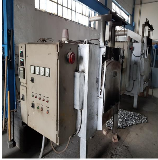
Şekil 4.13. Yangın dayanım tayini deneylerinde kullanılan tav fırınları
