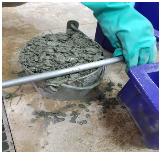
Şekil 4.5. Taze betonlar üzerinde yoğunluk tayini deneyi yapılırken kullanılan metal kova
