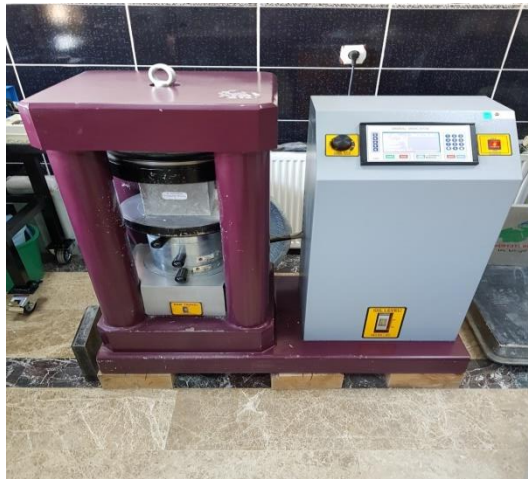
Şekil 4.8. Standart basınç mukavemet tayini deneylerinde kullanılan hidrolik basınç presi
