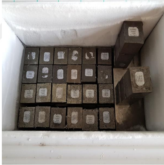
Şekil 4.11. Numunelerin donma çevrimi esnasındaki görüntüsü
