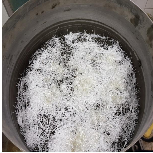
Şekil 4.1. Mikro ve makro fiber donatıların beton karışımlarına eklenmesi
