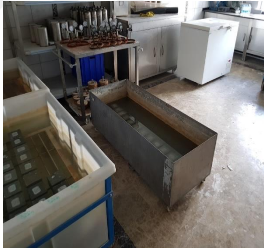
Şekil 4.12. Donma ve çözülme çevrimlerinin gerçekleştirildiği deney odası
