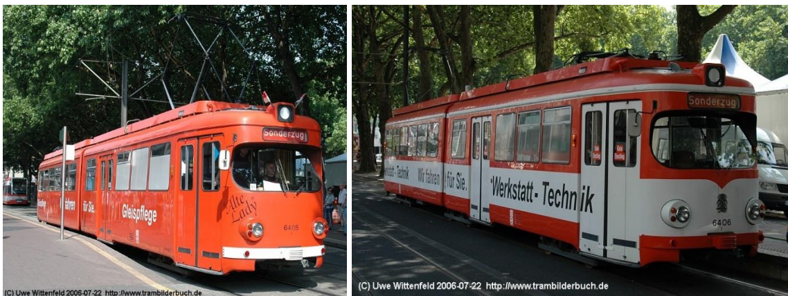
Şekil 4.6. Duewag GT8, 2 bölmeli ve 4 kapılı tramvay modelin görüntüleri (Wittenfeld 2006)
