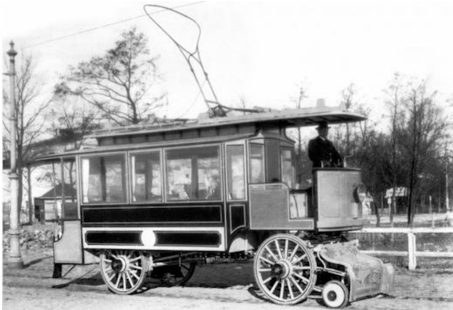
Şekil 2.26. Siemens'in 1898'de ürettiği "Trambus". Bizim günlerdeki tramvayların kullandıkları elektrik kablo yakalayıcılarına benzerlerini o dönemde artık kullanmışlar (Bruce 2017).
