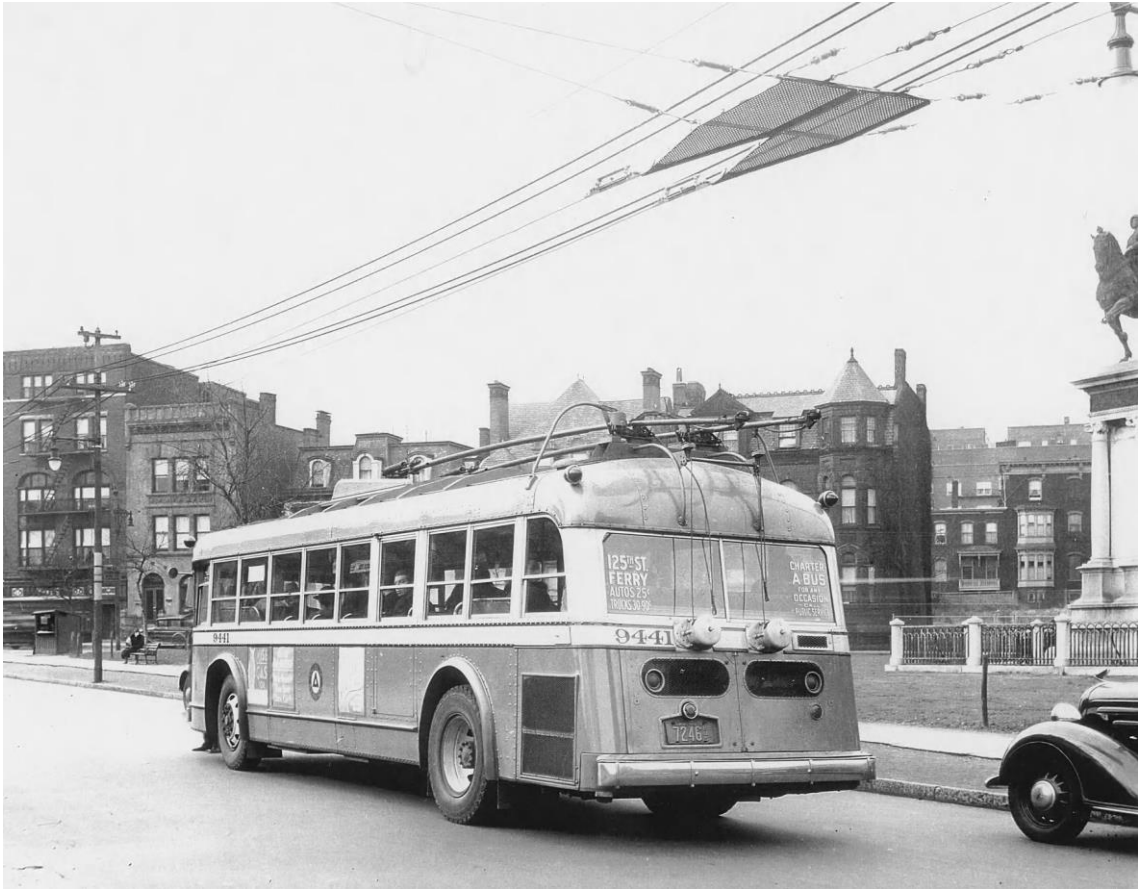
Şekil 2.27. Hybrid Trolleybüs. Hem Propan gazında hem elektrikle çalışabilir bu model 1935'te New Jersey'de hizmet etmişti (Vuchic 2007).
