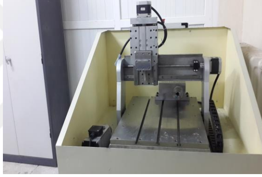
Şekil 3-12. SAN-TEZ projesi kapsamında alınan masa üstü CNC çekme numunesi hazırlama cihazı
