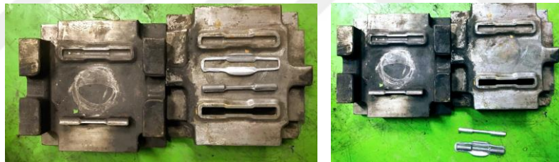
Şekil 3-9. Çekme numunesi dövme kalıbı ve dövülmüş numune.
