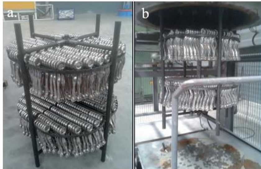
Şekil 2-7. Farklı açılardan yeni tasarım patentli ısıl işlem sepeti; ön görünüş a. Isıl işlem sepetinin fırından çıkışı b. (Küçükyağlıoğlu ve ark., 2015)
