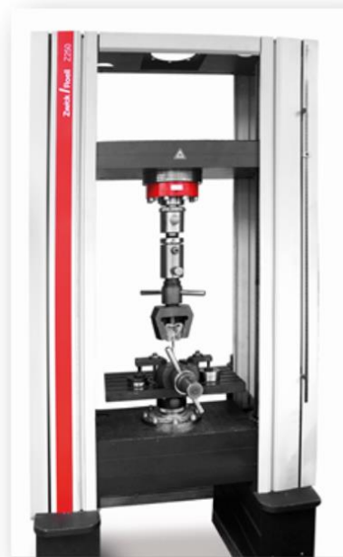
Şekil 3-13. Deneysel çalışmaların yapıldığı Zwick Roell 250 KN üniversal çekme basma test cihazı
