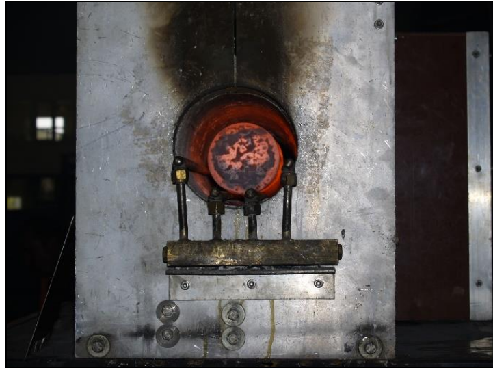
Şekil 3-3. Çelik dövmede indüksiyon ısıtma sistemi
