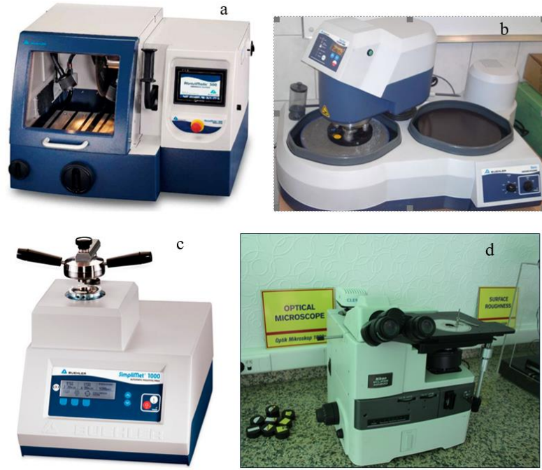
Şekil 3-10 Deneysel çalışmalarda kullanılan metalografik numune hazırlama cihazları; Kesme cihazı a. Polisaj makinası b. Kalıplama cihazı c. Metal mikroskobu d.
