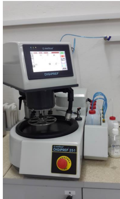
Şekil 3-11 SAN-TEZ projesi kapsamında alınan polisaj numune hazırlama cihazı
