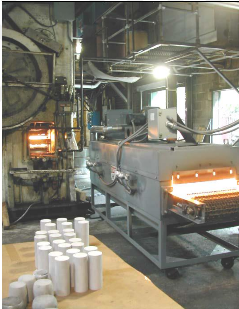
Şekil 3-5. Alüminyum dövmede infrared ısıtma uygulaması
