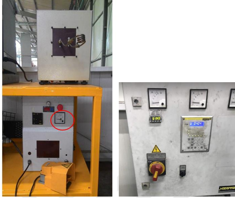
Şekil 3-19. İndüksiyon ön ısıtma ve rezistanslı fırın ön ısıtma cihazında akımölçer gösterimi
