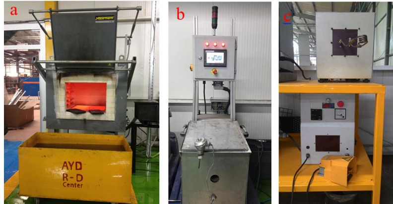
Şekil 4-1. Deneysel çalışmaların yapıldığı rezistans ısıtma fırını a. İnfrared ısıtma b. İndüksiyon ısıtma c. cihazları
