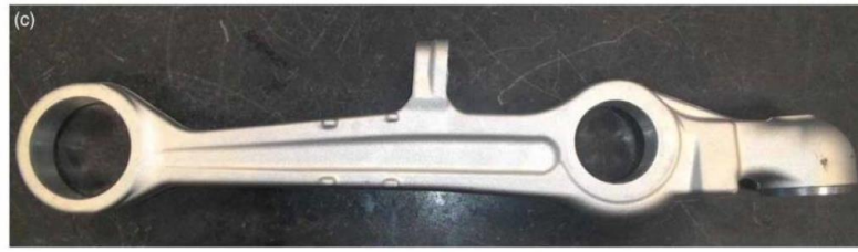
Şekil 2-15. Çalışmada kullanılan alüminyum dövme süspansiyon parçası (Gokcil ve ark., 2015).
