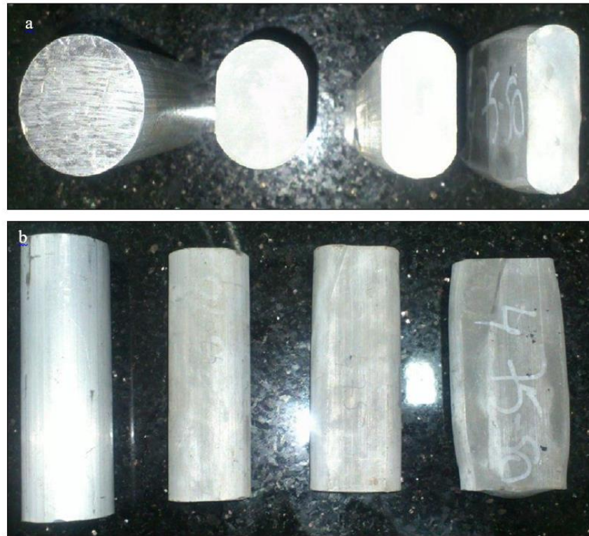
Şekil 3-17 Dövülen numuneler ekstrüzyona dik a. ekstrüzyon paralel b. görselleri yer almaktadır.
