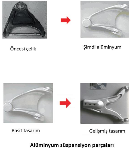
Şekil 2-33 Alüminyum süspansiyon parça ve tasarım örnekleri (Bouazara, 2009)
