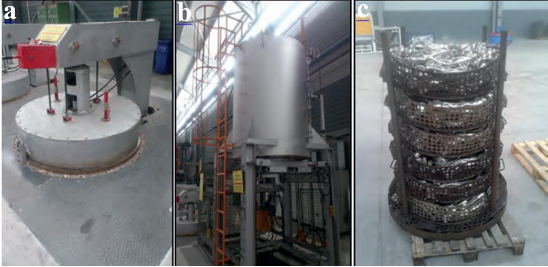
Şekil 2-6. Alüminyum ısıl işlem prosesinde; Yaşlandırma fırını a. Çözeltiye alma fırını b. Eski sistem ısıl işlem sepeti c. (Küçükyağlıoğlu ve ark., 2015)
