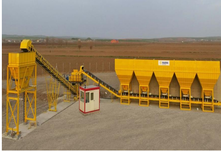
Şekil 2.11. Mekanik stabilizasyon plenti
