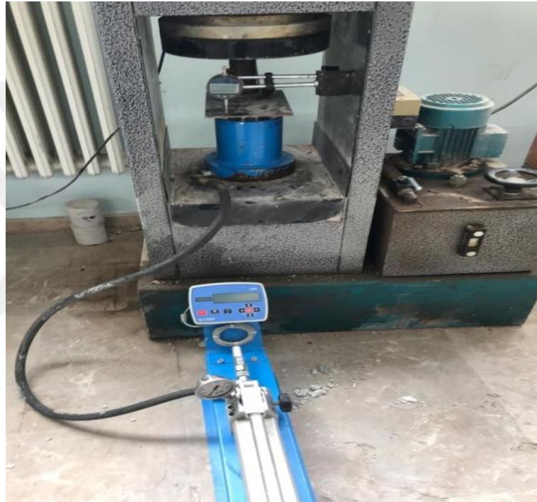
Şekil 3.4. Kalibre edilen plaka yükleme deney aleti
