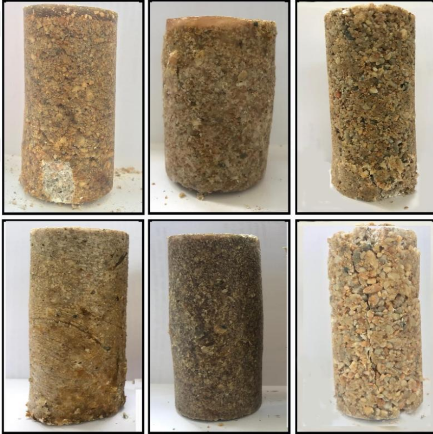
Şekil 4.3. Serbest basınç deneyinden sonra bazı numunelerin görünümü
