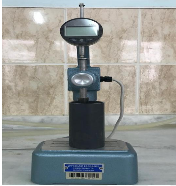
Şekil 3.5. Sertleşme sürelerinin tayininde kullanılan koni penetrasyon aleti
