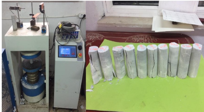
Şekil 4.2. Tek eksenli basınç deneyinde kırılmış numuneler
