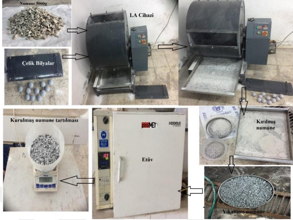
Şekil 3.13. Los Angeles deneyin yöntemi
