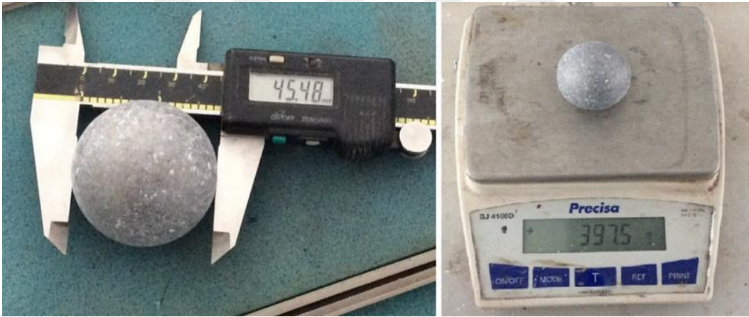
Şekil 3.12. Los Angeles deneyinde kullanılan çelik bilya
