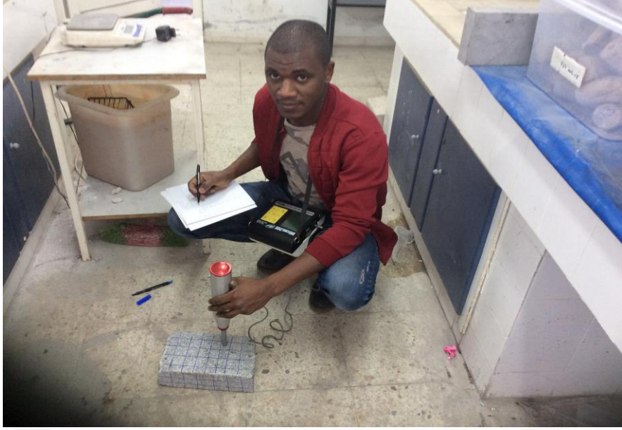
Şekil 4.1. Sertlik deney prosedürü
