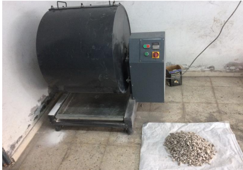
Şekil 3.6. Los Angeles deney cihazı ve numuneleri
