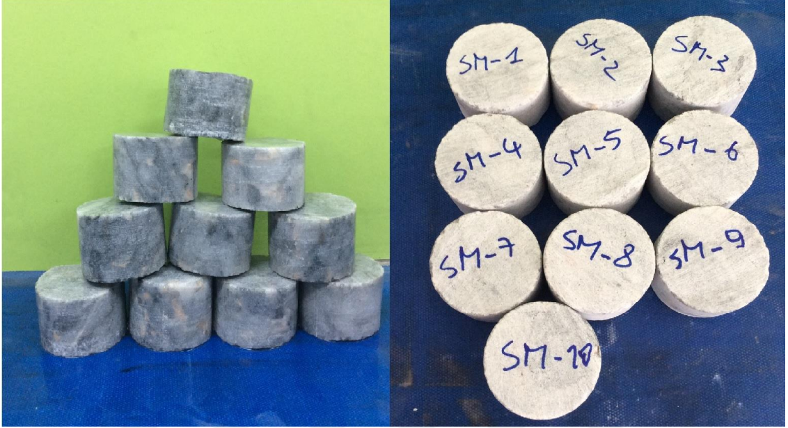
Şekil 3.1. Yoğunluk ve porozite numuneleri
