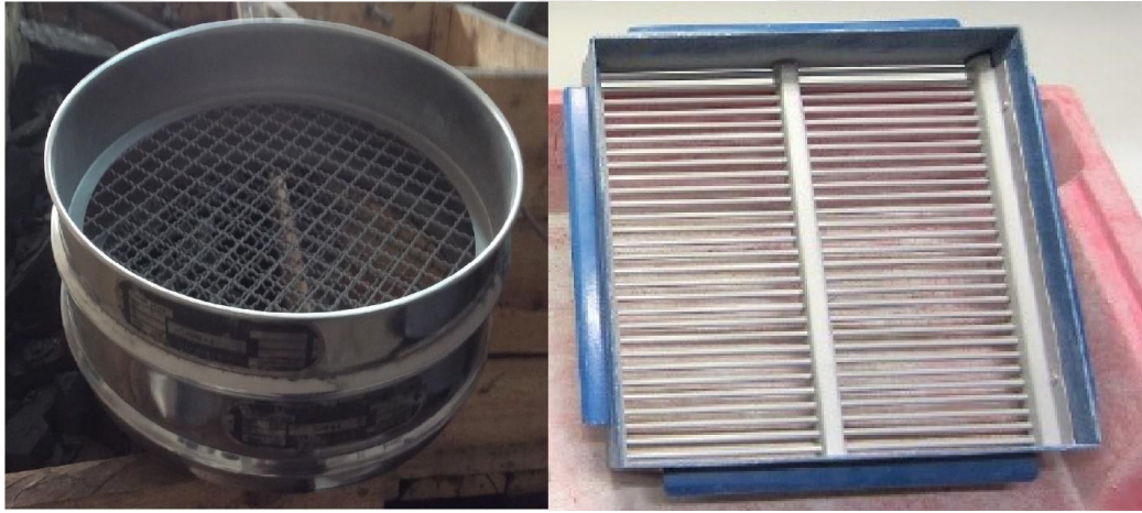
Şekil 3.11. Yassılık indeksi tayinde kullanılan kare gözlü ve silindirik çubuklu elekler
