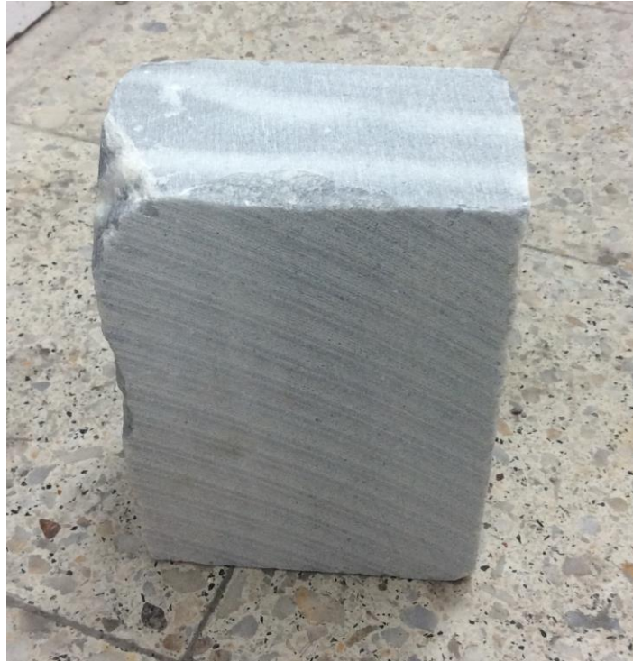
Şekil 3.2. Sertlik belirlemek için kullanılan kaya blok örneği
