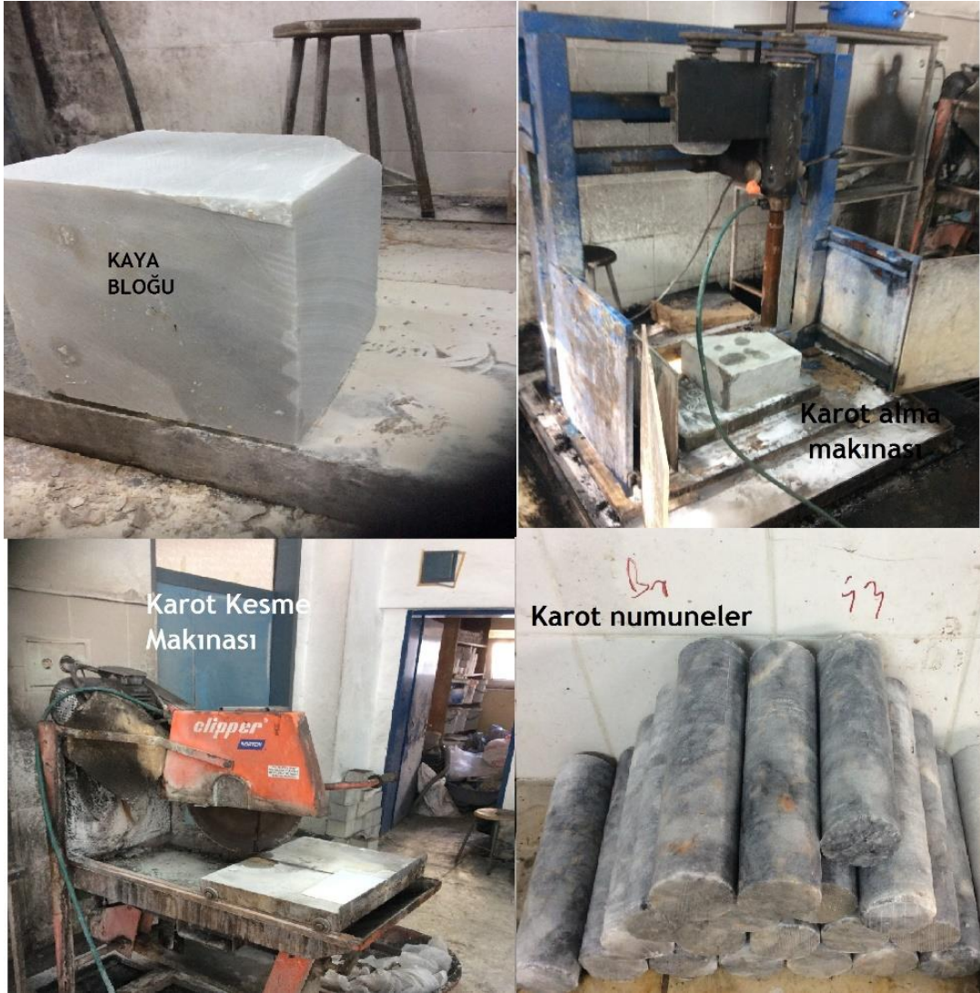
Şekil 3.3. Karot alma ve kesme ekipmanları ve numuneler
