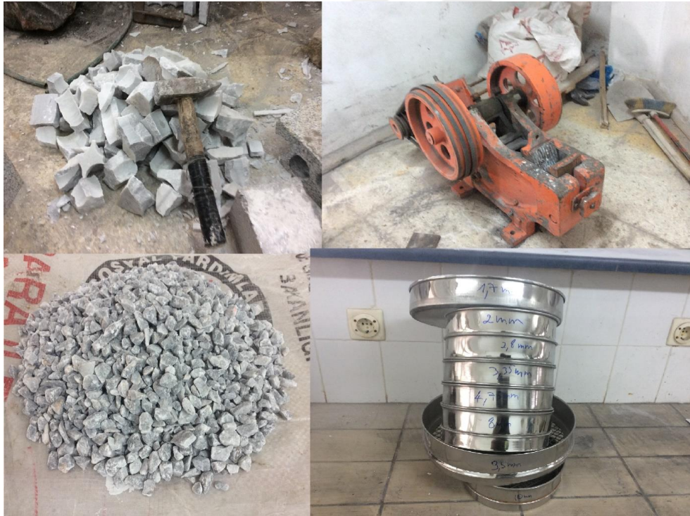
Şekil 3.4. Elek analizinin numuneleri ve kullandığı elekler
