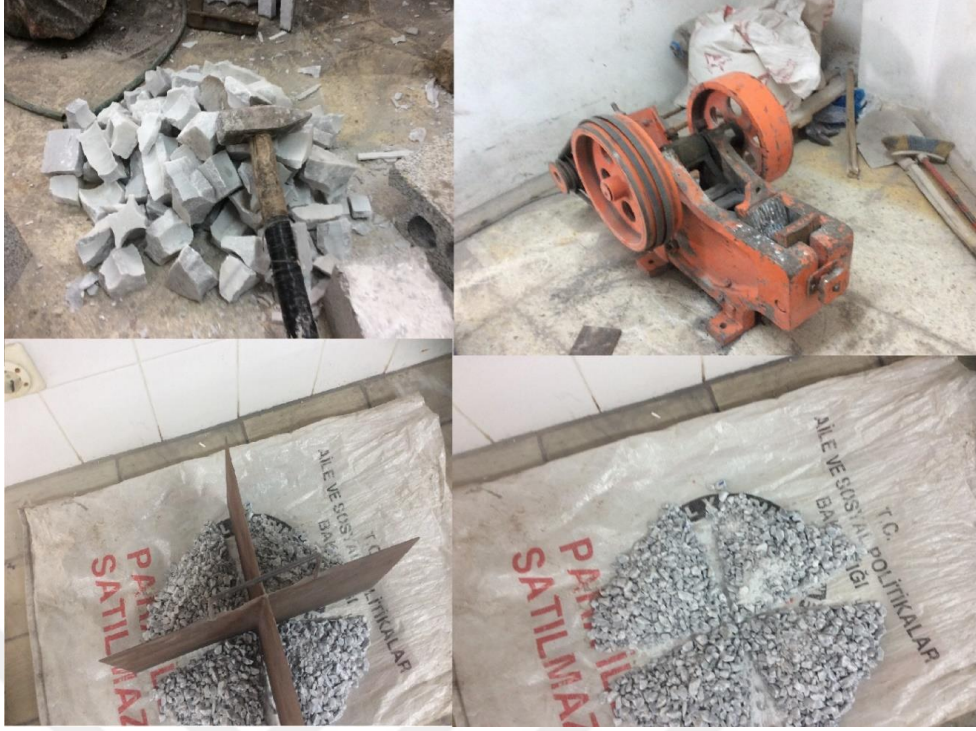
Şekil 3.5. Şekil faktörü tayini için numunelerin hazırlanması
