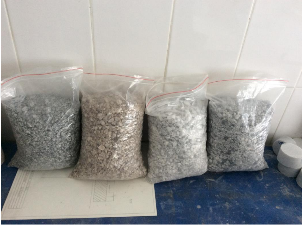
Şekil 3.7. Kırılabilirlik indeksi deneyinde kullanılan numuneler
