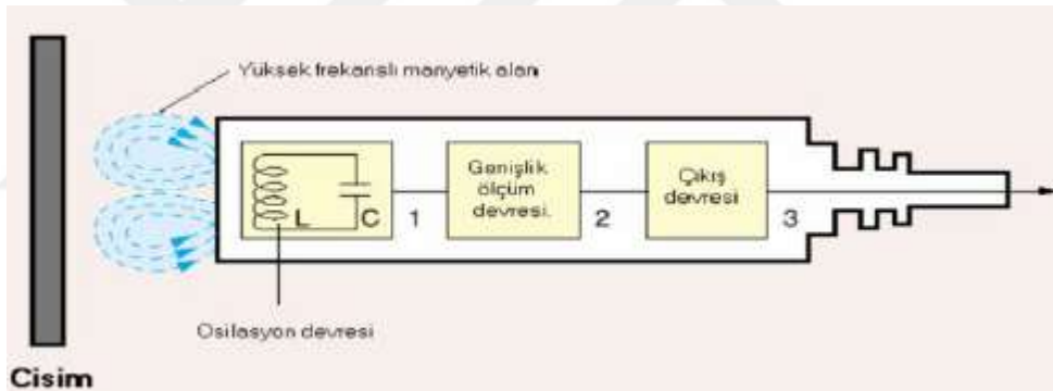
Şekil 3.21. Elektronik devreli manyetik sensör (Anonim, 2012)
