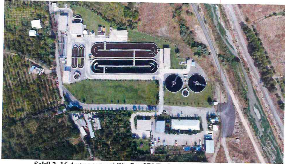
Şekil 2. 16 Arıtma prosesi Bio-P + SDNP olan bir AAT'nin görüntüsü
