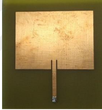
Şekil 3.49. Üretimi yapılan antenin üstten görünüşü
