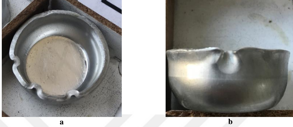
Şekil 7.33. 1,0 mm kalınlıktaki malzemenin erichsen derin çekme testi sonucunda görülen yırtılmanın üstten görünüşü a -Çift yönlü haddelenen b -Tek yönlü haddelenen
