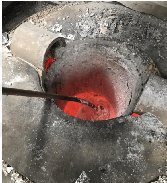
Şekil 6.2. Döküm esnasında azot gazı ile karıştırma
