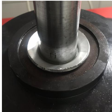
Şekil 7.30. Erichsen derin çekme testi esnasında alınan görüntü
