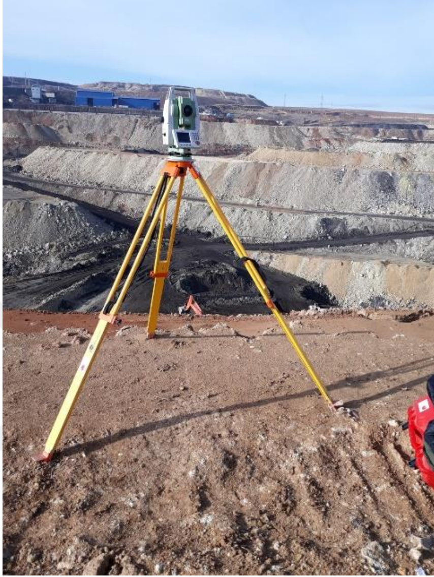
Şekil 3.9. Ölçüm için kullanılan Leica TS09 Plus total station cihaz kurulumu
