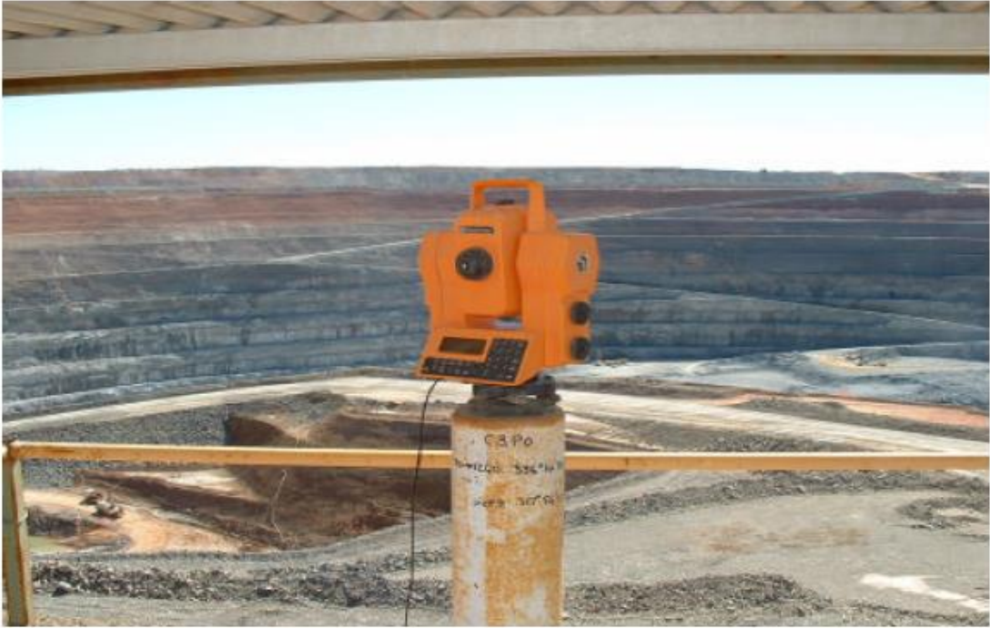
Şekil 2.3. Duraylı noktada pilye üzerine monte edilmiş teodolit (Pektaş, 2005)
