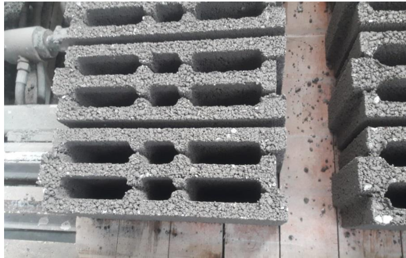
Şekil 4.16. %20 ikame oranlı numune basımı
