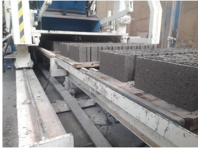
Şekil 4.18. %40 ikame oranlı numune basımı
