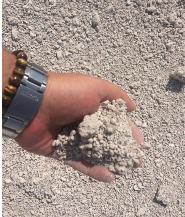
Şekil 4.5. Pomza eleme ve temizlemeden önce
