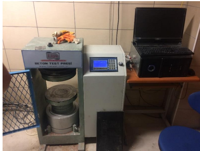
Şekil 4.30. Basınç dayanım deneyi (deney cihazı pres)
