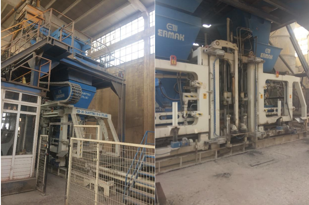
a- Helezon ve kayar bantların olduğu bölüm b- Kalıp ve hammadde dolum bölümü
