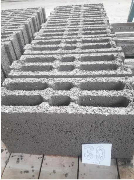
Şekil 4.17. %30 ikame oranlı numune basımı
