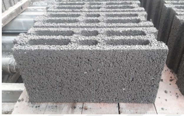
Şekil 4.2. Çalışmada üretilen bims blok numunesi
