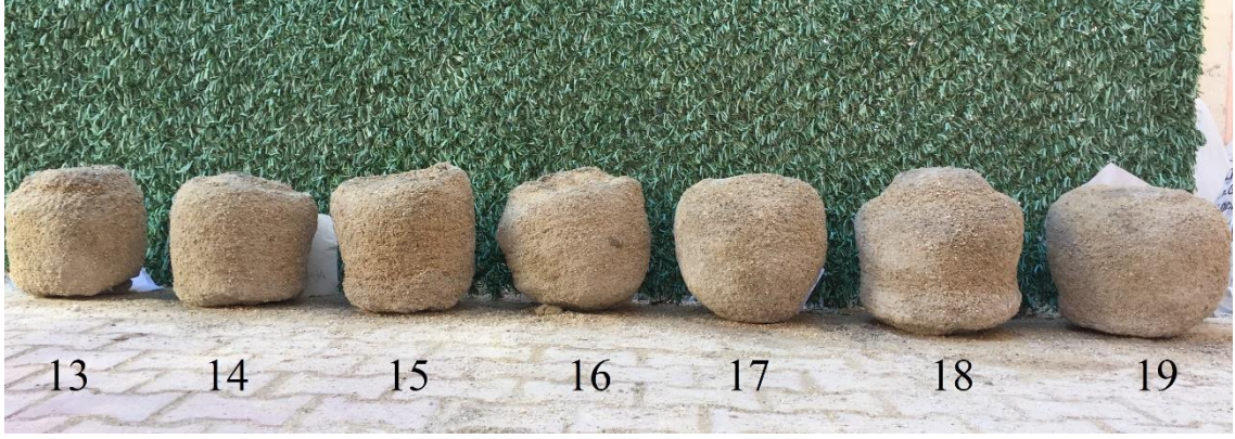
Şekil 4.7. DMFC-800 çimentosuyla üretilen JG kolonları.
