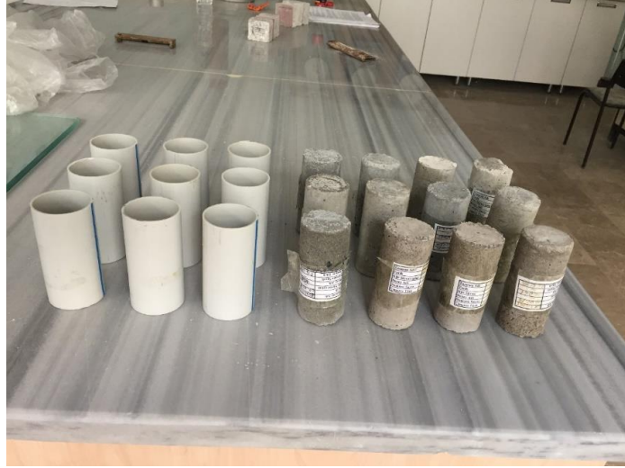
Şekil 3.10. Elle karıştırılarak hazırlanan küçük numunelerin hazırlanması
