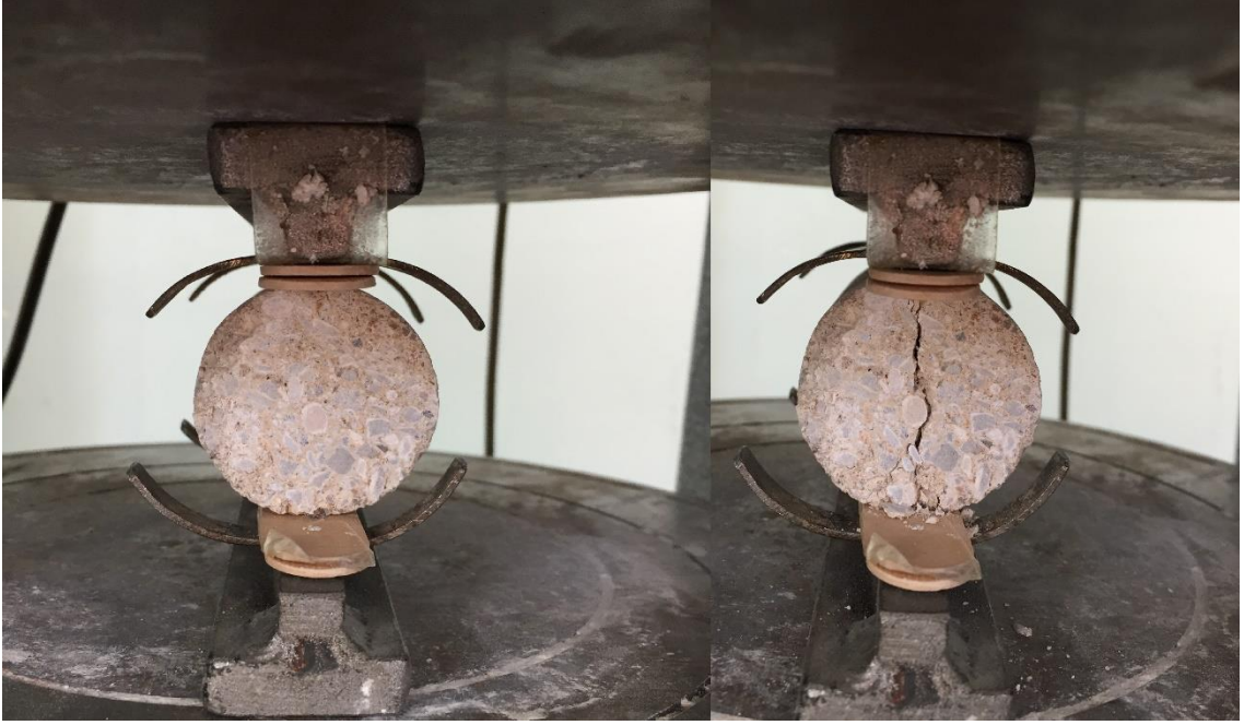
Şekil 3.21. Yarmada çekme dayanımının belirlenmesi
