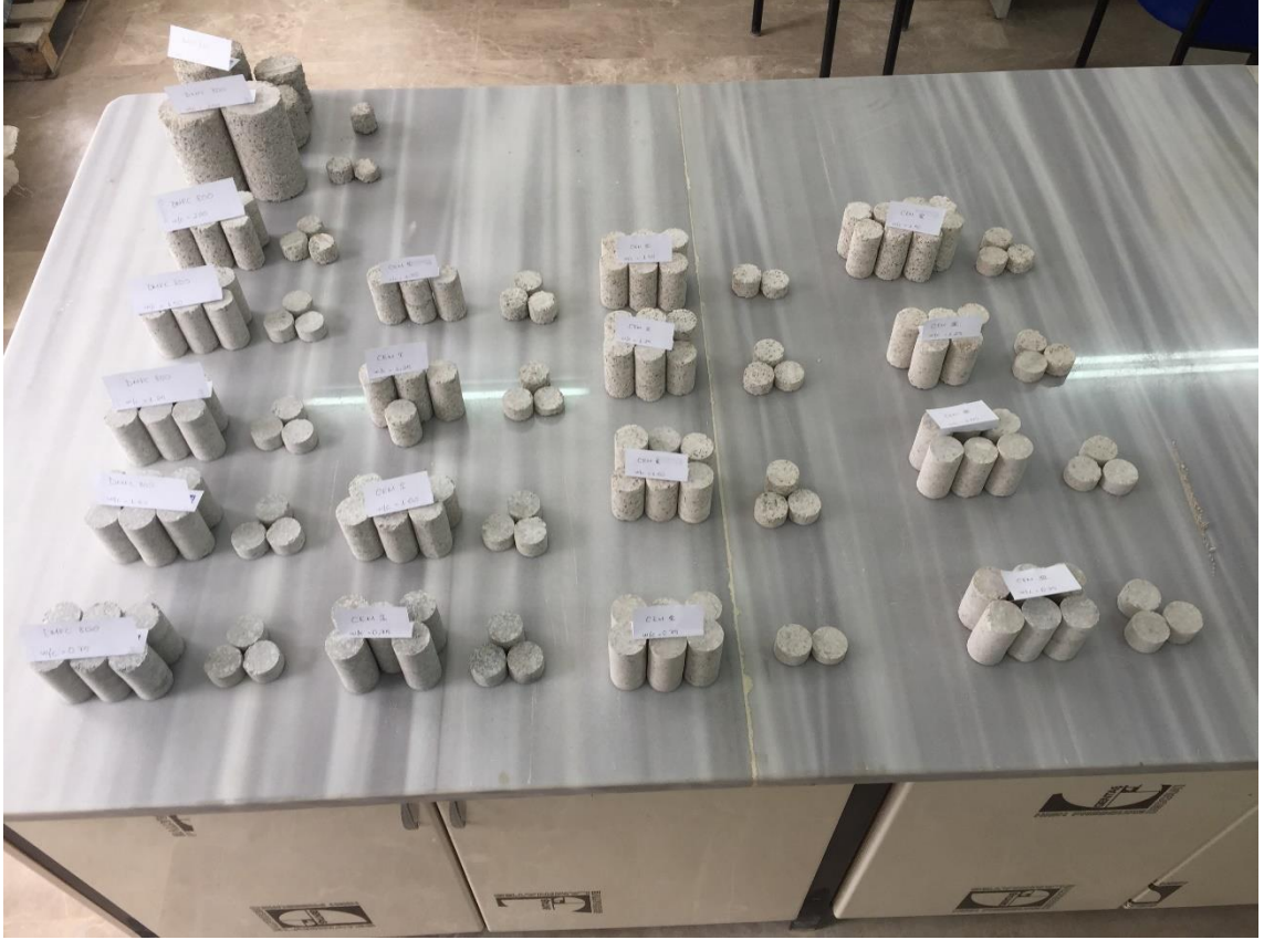
Şekil 3.19. Çap-boy oranları 0.5 olarak ayarlanan ve yüzeyleri düzeltilen karot numuneleri
