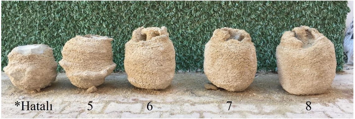
Şekil 4.5. CEM II çimentosuyla üretilen JG kolonları
