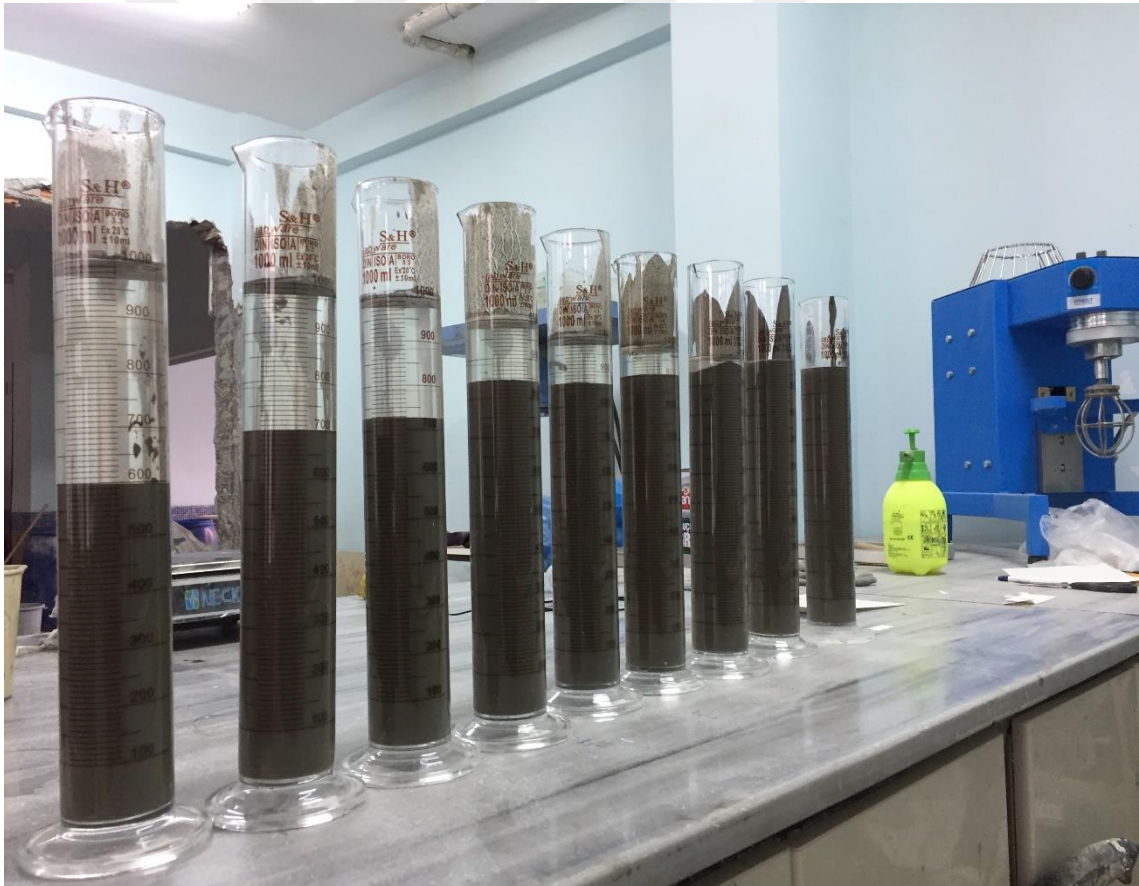
Şekil 3.7. Sedimentasyon deneylerinin yapılması.
