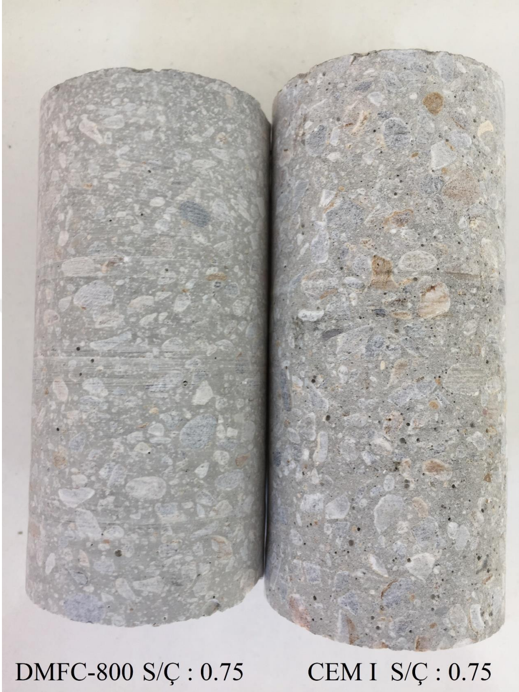
Şekil 4.41. DMFC-800 ve CEM I çimentolarının S/Ç oranı 0.75 olan model JG kolonlarından alınan karot örneklerinin karşılaştırmalı görüntüsü.
