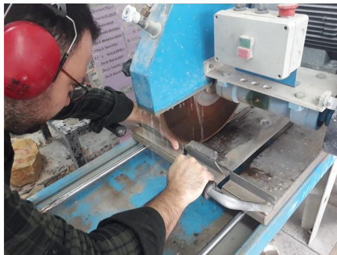
Şekil 3.18. JG kolonlarından alınan karot numunelerinin kesilmesi
