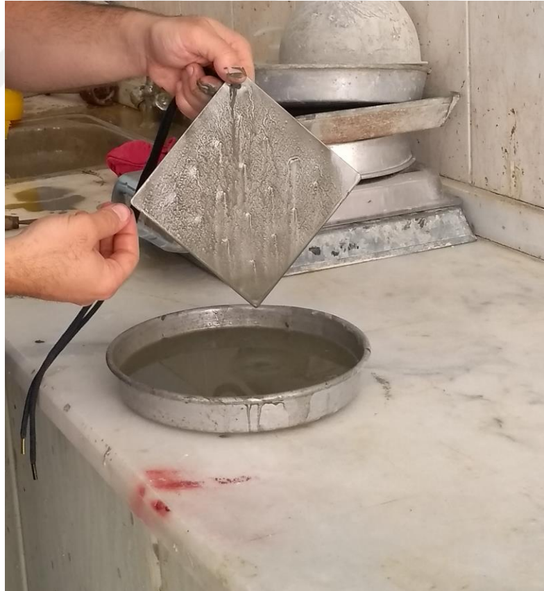
Şekil 3.5. Levhanın enjeksiyon sıvısına daldırılması
