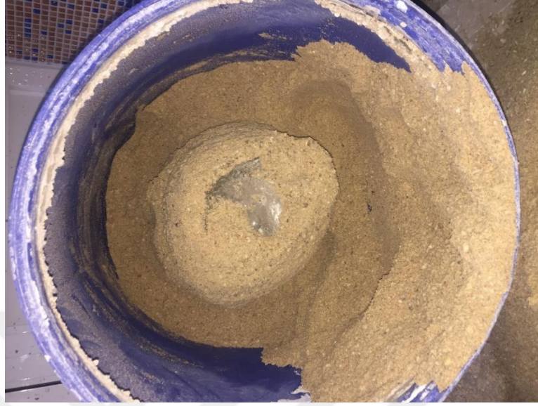
Şekil 3.15. JG kolonlarının varillerden çıkarılması
