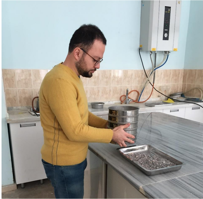
Şekil 3.1. Elek analizi deneyinin yapılması
