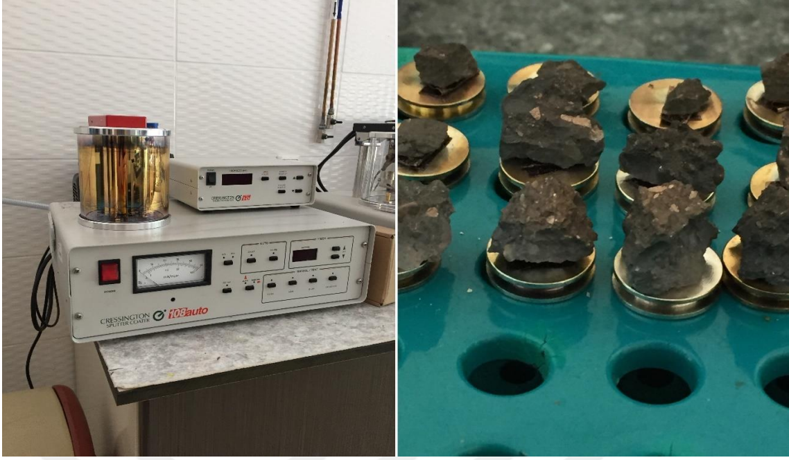
Şekil 3.25. Numunelerin iletkenliğini sağlamak için altın kaplanması.
