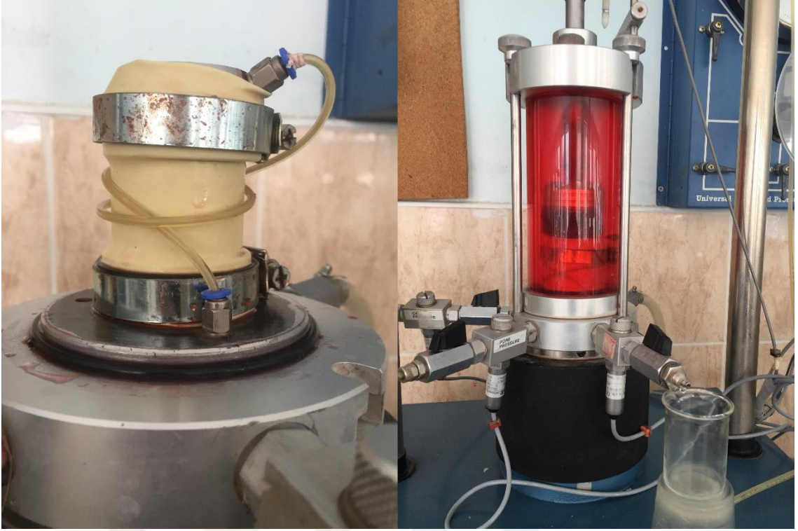
Şekil 3.24. Geçirimsizlik deneylerinin yapılması
