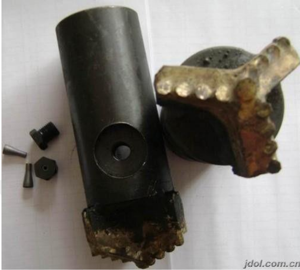
Şekil 2.7. Jet Grout monitör, delici uç ve nozul ekipmanı (anchordrillingrig.com)
