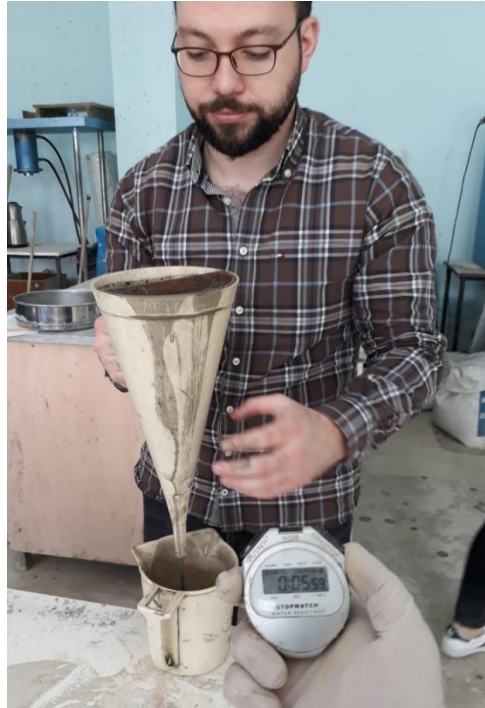
Şekil 3.4. Marsh hunisi deneyinin yapılması.
