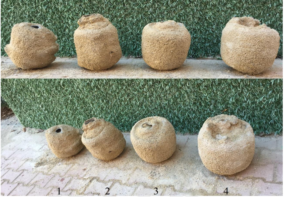
Şekil 4.4. CEM I çimentosuyla üretilen JG kolonları.
