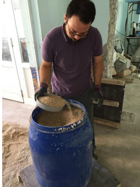
Şekil 3.12. Kumlu zeminin belirlenen sıklıkta varillere yerleştirilmesi
