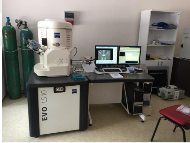
Şekil 3.26. Taramalı Elektron Mikroskobu (SEM) ekipmanı
