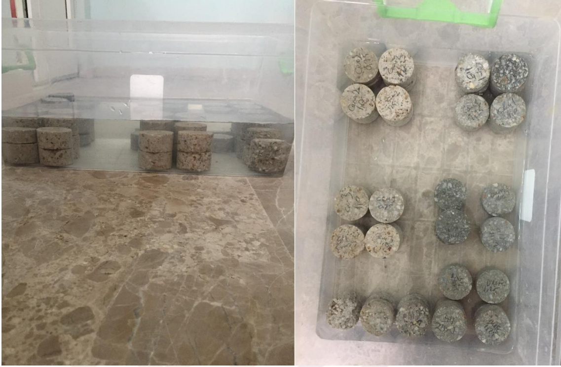
Şekil 3.23. Geçirimsizlik numunelerinin suya doymun hale getirilmesi
