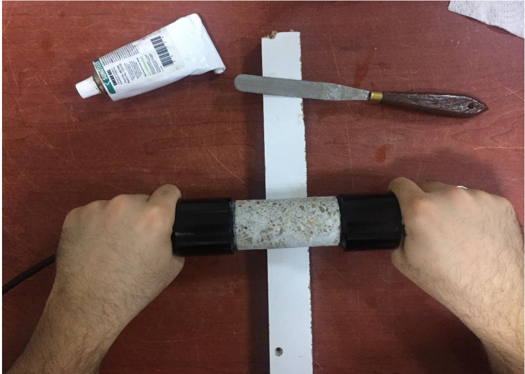
Şekil 3.30. UPV ölçümlerinin yapılması.
