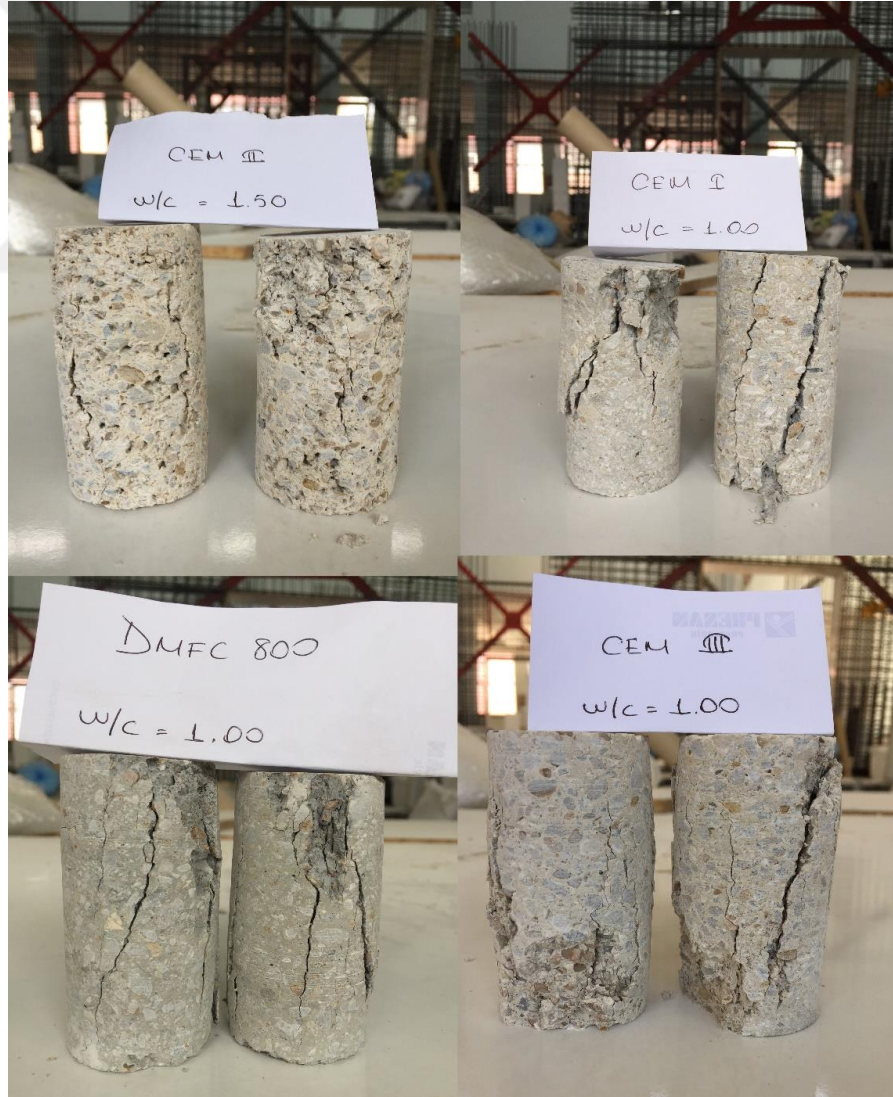
Şekil 3.20. Serbest basınç deneyinde kırılan numuneler.
