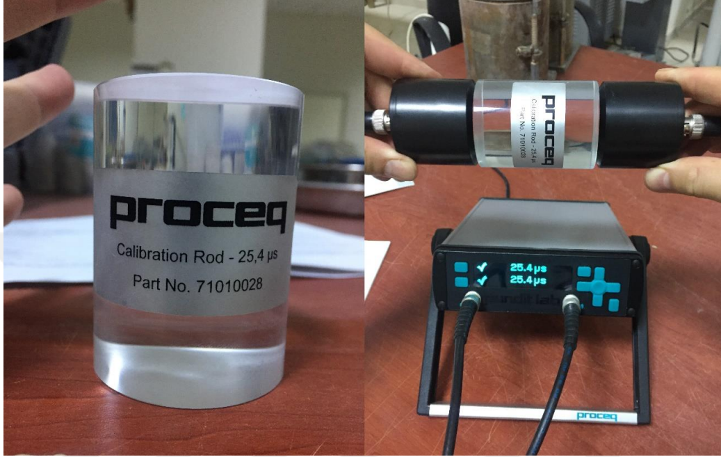
Şekil 3.29. UPV cihazının kalibrasyonunun yapılması.
