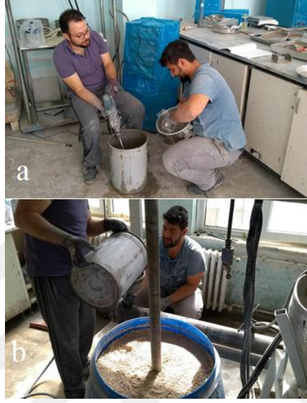
Şekil 3.13. a) Enjeksiyon karışımının hazırlanması, b) Enjeksiyon karışımının pompaya doldurulması
