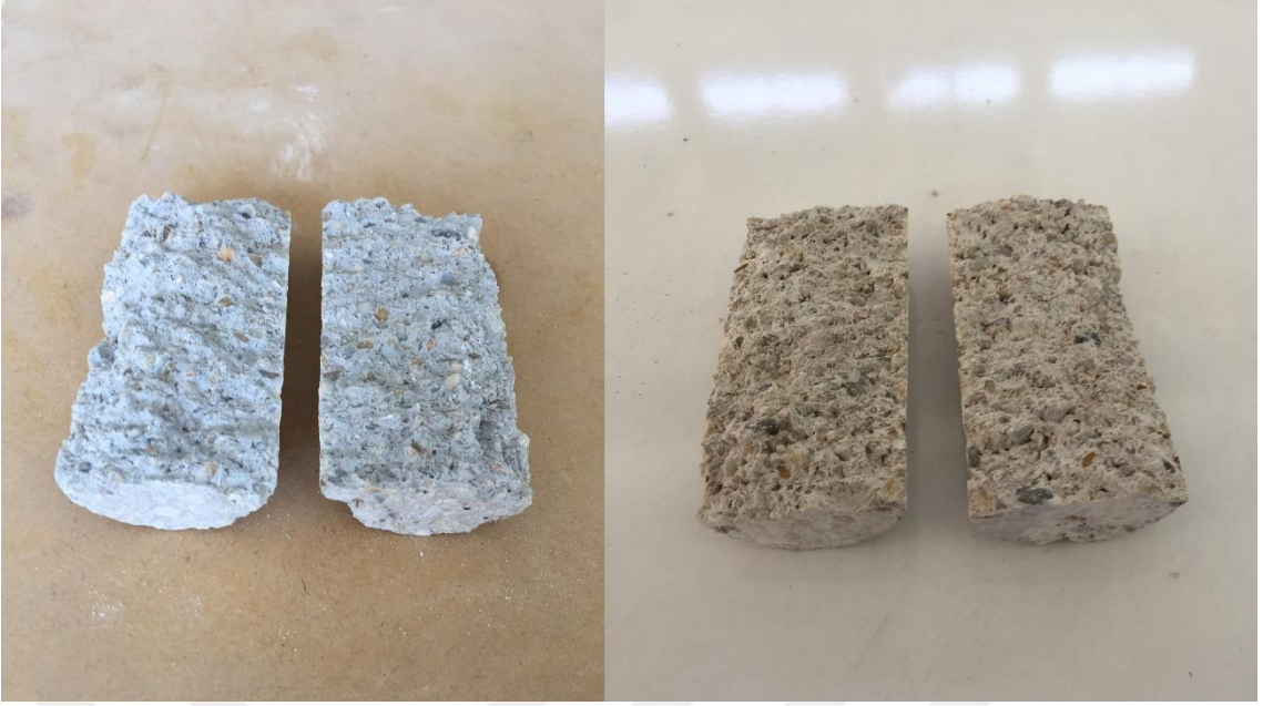
Şekil 3.22. Silindir numunenin merkezindeki dikdörtgen düzlem boyunca kırılan (yarılan) numuneler
