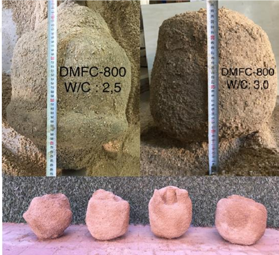
Şekil 3.16. Kür süresinin sonunda kum içerisinde çıkarılan JG kolonları.
