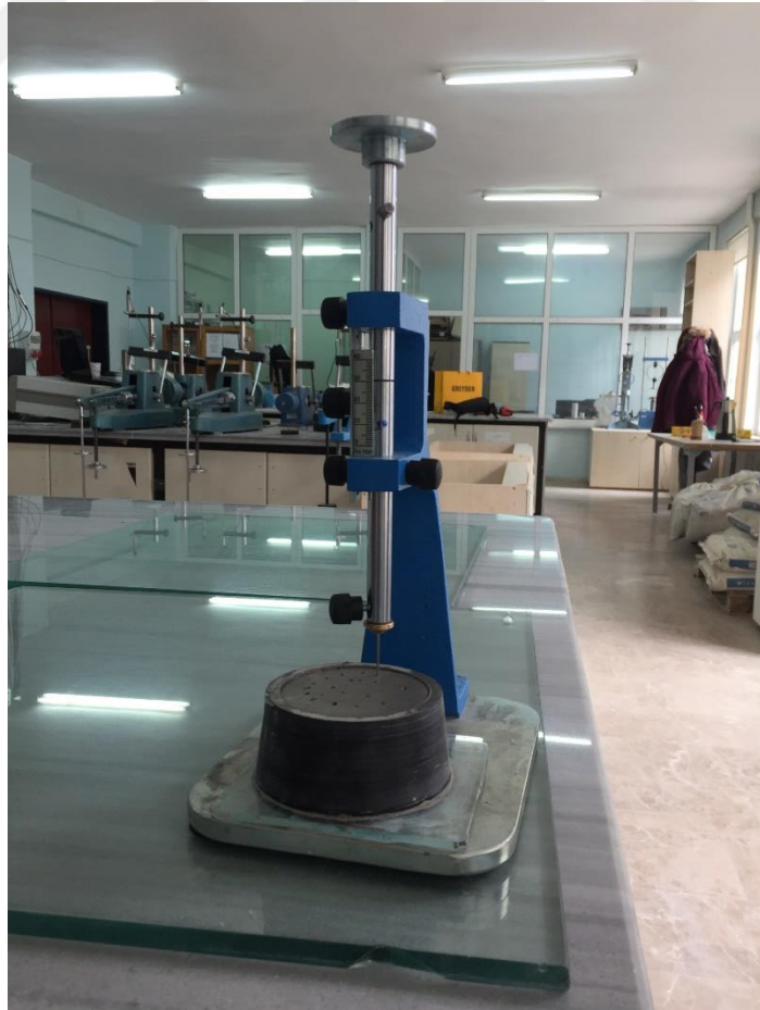
Şekil 3.9. Vicat iğnesi deneylerinin yapılması.
