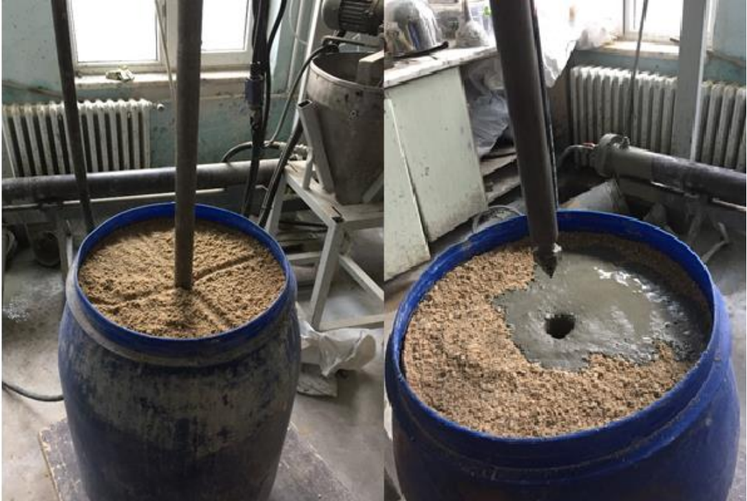
Şekil 3.14. Jet enjeksiyon işleminin gerçekleştirilmesi
