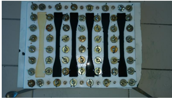
Şekil 3.8. Kompozit numuneler için kullanılan kalıp
