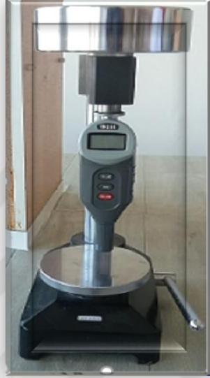
řekil 3.10. Sertlik tayini için kullanılan cihaz
