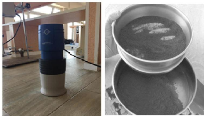
Şekil 3.6. Öğütücü cihazı EPDM tozunun elek altı görüntüsü
