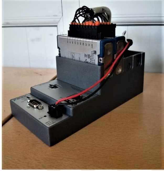
Şekil 7.12. Deney düzeneğinde kullanılan kontrol cihazı ve giriş-çıkış modüllerinin yapılandırılmış hali.
