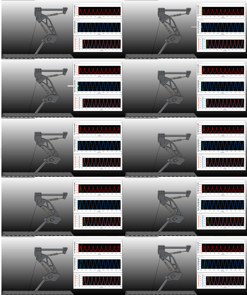
Şekil 5.9. Bacak modelinin 0,5 Hz frekansında ve 13 cm genliğinde dikey salınım hareketinin analizi sırasında elde edilmiş ekran görüntüleri dizisi. Kareler arasında geçen süre 0,2 sn'dir.
