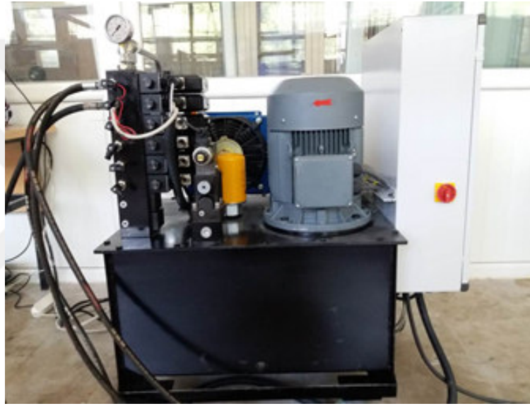
Şekil 7.3. Deney düzeneğinde kullanılan hidrolik güç ünitesi.
