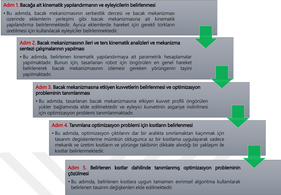
Şekil 4.14. Tez çalışması kapsamında optimal kuvvet iletimine sahip bir bacak mekanizması geliştirebilmek için izlenen metodolojinin akış şeması şeklinde gösterimi.
