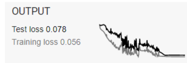
Şekil 4.4. Konvolüsyon bulunmayan YSA'nın eğitim maliyeti ve test maliyeti değerleri grafik gösterimi, devir sayısı = 10
