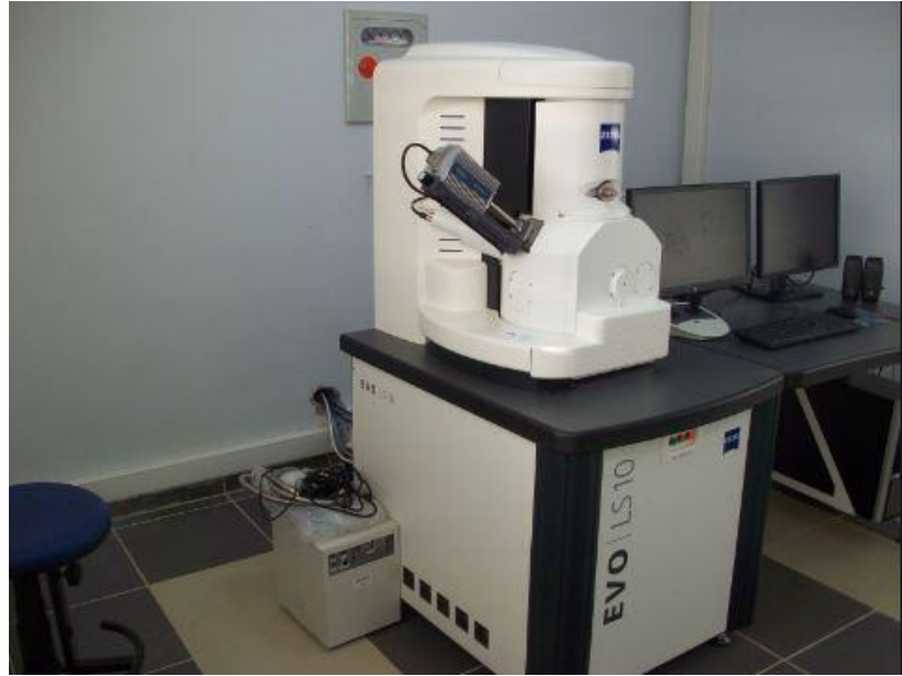
Şekil 4.17. SEM, Zeiss Evo LS10 Cihazı (SU, Iltek laboratuvar)
