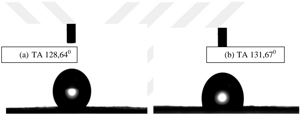
Şekil 5.12. Nano liflerin temas acısı (a) Ağırlıkça %11 PAN/DMF (b) Ağırlıkça %11 PAN/DMF + %1 silika
