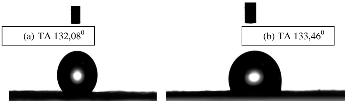
Şekil 5.13. Nano liflerin temas acısı (a) Ağırlıkça %12 PAN/DMF (b) Ağırlıkça %12 PAN/DMF + %1 silika
