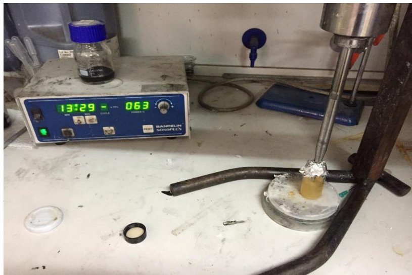
Şekil 4.4. Ultrasonik karıştırıcı ile PAN/DMF çözeltisinin hazırlanması
