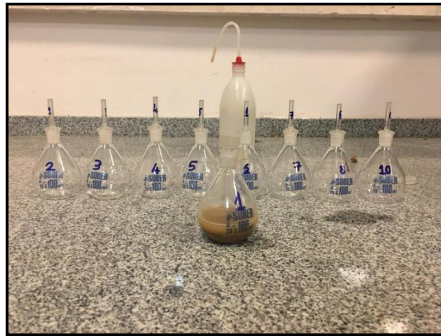
Şekil 6.5. Özgül ağırlık deneyi yapılışı
