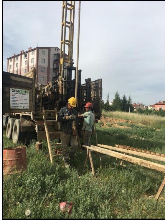
Şekil 6.4. SK-3 numaralı kuyudan UD numunesi alımı
