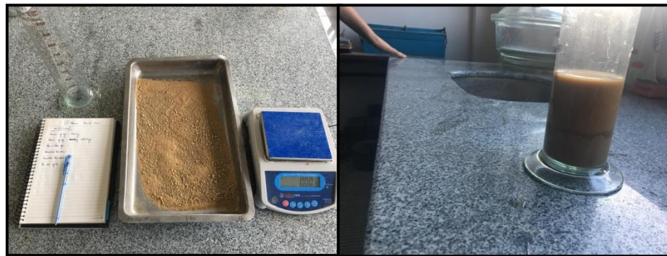
Şekil 6.9. Min./Max. boşluk oranı tayini deney düzeneği ve yapılışı
