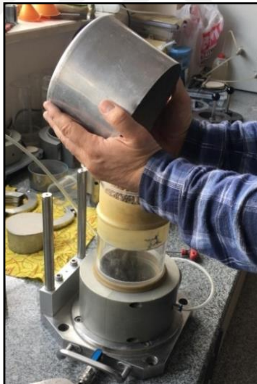
Şekil 6.18. Kum örneklerinin tekrarlı basit kesme deneyine hazırlamakta kullanılan numune hazırlama aparatına/kalıbına kumun yerleştirilmesi
