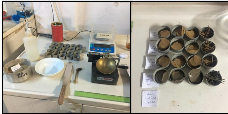
Şekil 6.8. Atterberg Limitleri tayini deney düzeneği ve yapılışı
