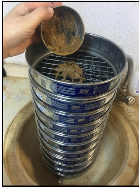
Şekil 6.6. Elek analizi deneyi yapılışı
