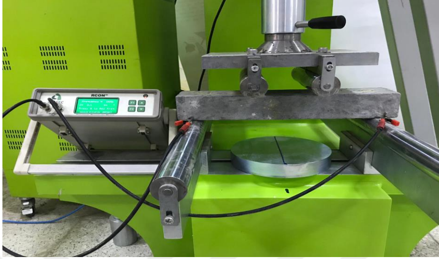
Şekil 3.26 Kiriş numuneler için kararlaştırılan 2 noktalı (AC) ölçüm yöntemi
