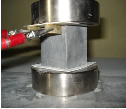
a) elektrotların üste yerleştirilmesi
