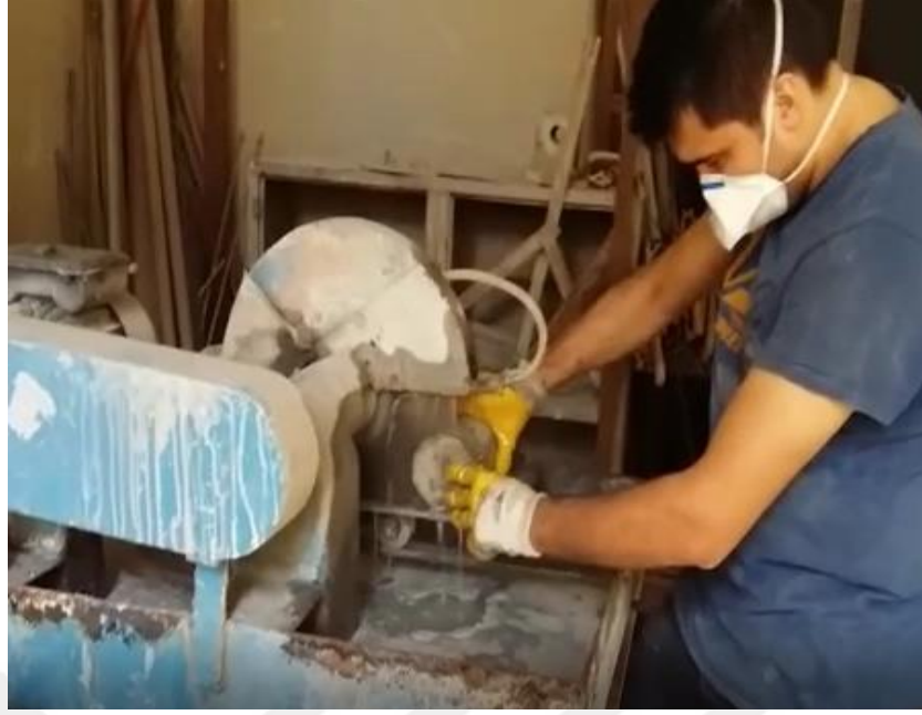
Şekil 3.17 Ø100×200 mm boyutlarındaki silindir numunelerin HKİG testi için kesilerek uygun hale getirilmesi
