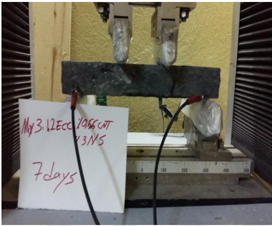
c) 3. Karışım-ECC-%0,55 Karbon nanotüp-%3 Nano silika
