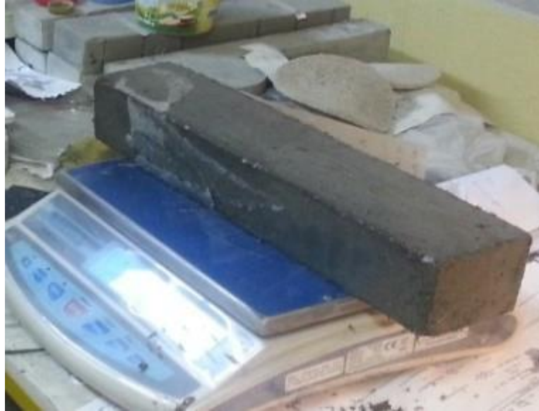
Şekil 3.29 Donma-çözülme çevrimleri sonrası kiriş numunelerin ağırlık kaybının belirlenmesi
