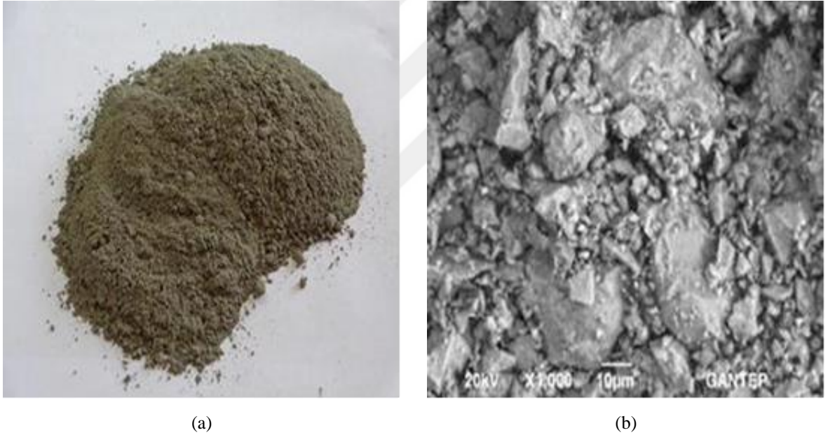
Şekil 3.1 CEM I 42,5R Portland çimentosunun (a) dijital kamera ve (b) SEM görüntüsü
