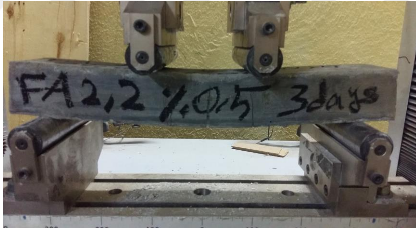
(b) yüksek dereceden sünek ECC malzemesinin eğilme altında görünüşü
