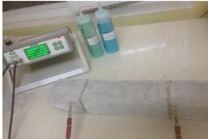
(i) Kiriş numunelerde iletken jellerle elektriksel direnç ölçümü
