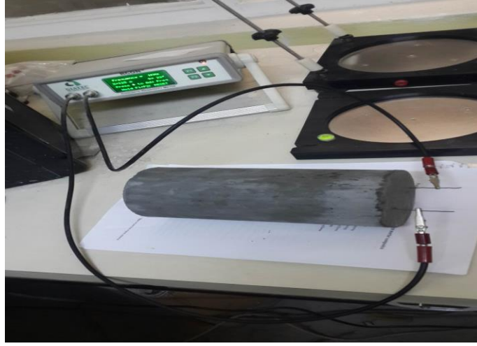
(g) Silindir numunelerde çelik çubuklarla elektriksel direnç ölçümü
