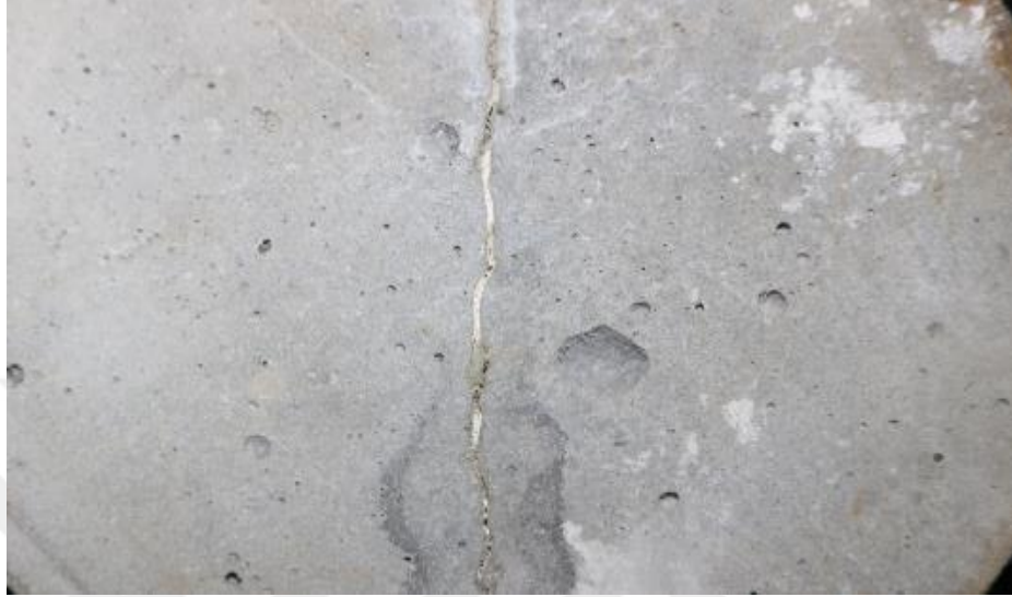
Şekil 1.5. Karşılıklı çatlak yüzeyleri arasında yer alan kalsiyum karbonat ürünleri
