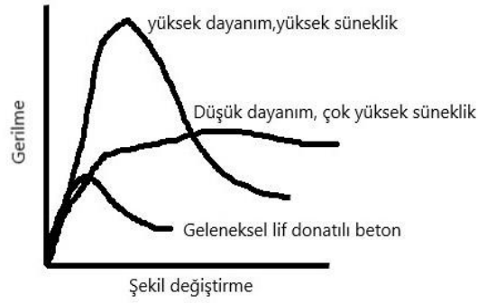
(a) Çeşitli lif donatılı çimento esaslı malzemelerin gerilme-şekil değiştirme davranışı
