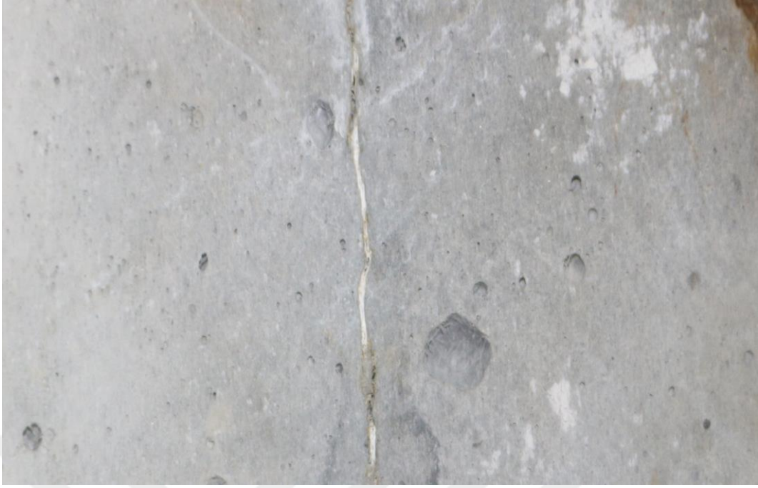
Şekil 4.68 Nano malzemelerle modifiye edilmiş silindir ECC numunelerinin geniş açıklıktaki çatlaklarının kendiliğinden iyileşmesi
