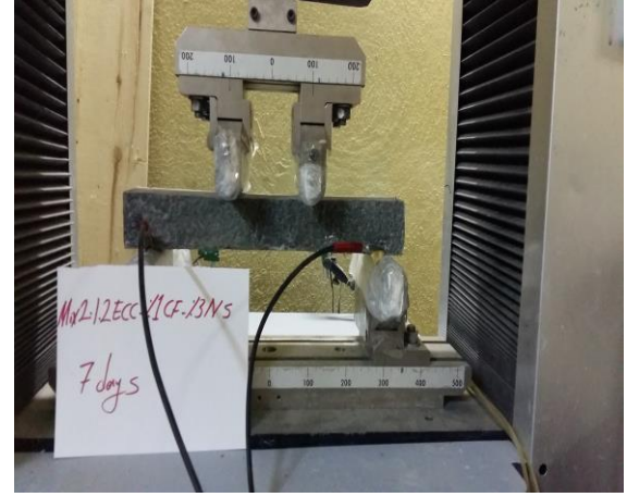
b) 2. Karışım-ECC-%1 Karbon lif-%3 Nano silika
