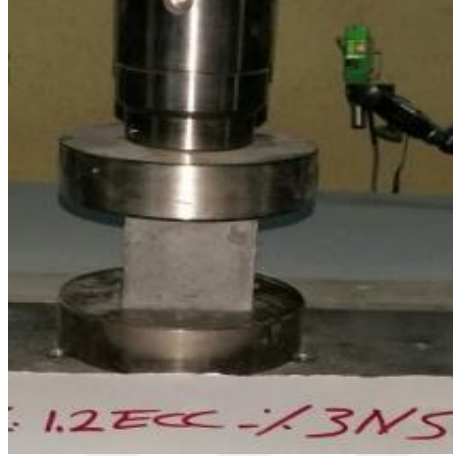
Şekil 3.34 Nano ve mikro malzemelerle modifiye edilmiş ECC küp numunelerin basınç dayanımı deneyi
