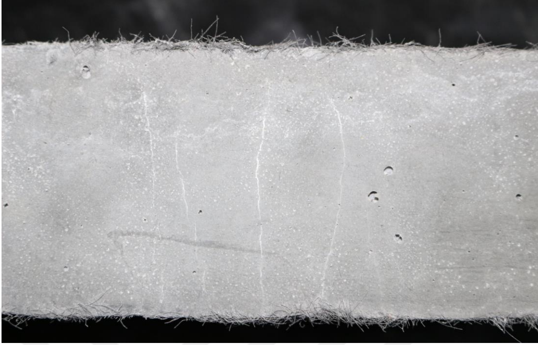
Şekil 4.70 Nano malzemelerle modifiye edilmiş kiriş ECC numunelerinin bütün çatlaklarının kendiliğinden iyileşmesi
