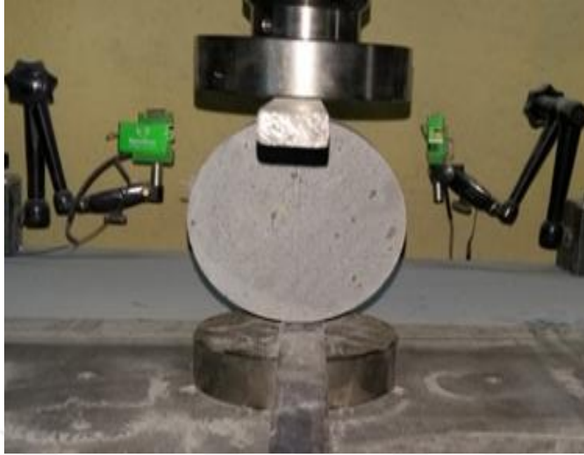
Şekil 3.19 Numunelere ön yükleme ile hasar verilmesi (maksimum taşıma gücünün %75'i seviyesinde)
