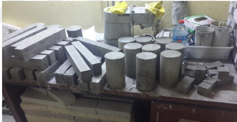
a) farklı ebatlarda dökülen numuneler
