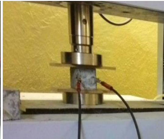
f) yalıtım için kullanılan ahşap plakalar
