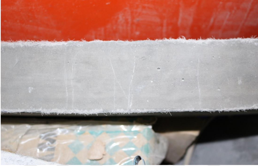
Şekil 4.66 Nano malzemelerle modifiye edilmiş ECC numunelerinin bütun çatlaklarının kendiliğinden iyileşmesi
