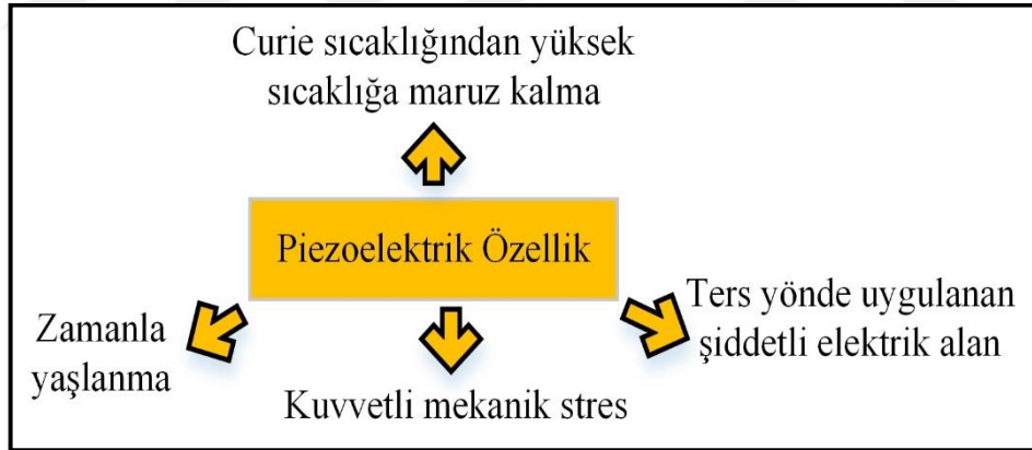
Şekil 1.10 Piezoelektrik özeliğin bozulması (Malysh ve Erhart, 2005)
