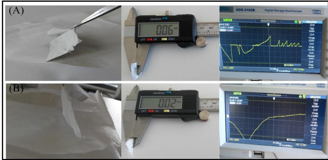
Şekil 4.8. P-E malzemenin kalınlığı ve ölçüm sonucu incelemesi
