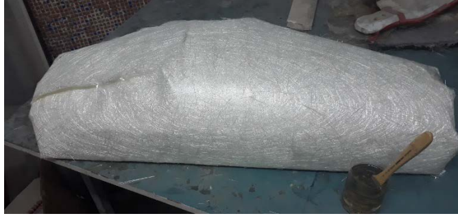
Şekil 3.6. Polyester emdirilmeye hazır cam elyaf
