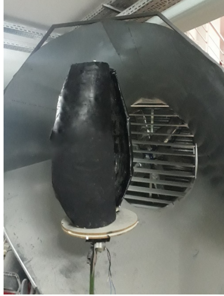
Şekil 3.7. Çevresi kaplanarak boya işlemi yapılmış Savonius türbini rüzgar tüneli önünde.
