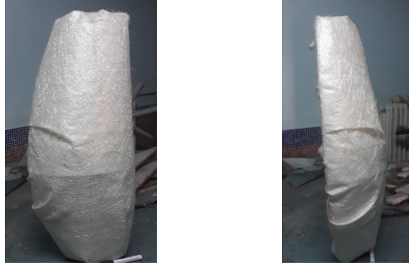
Şekil 3.5. Cam elyaf ile sarılmış kalıp
