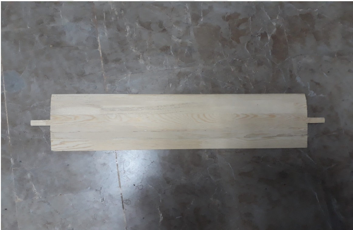
Şekil 3.10. Darrieus rüzgar türbini kanadı imalatı.
