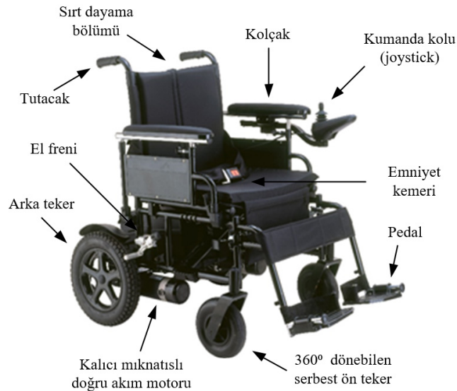
Şekil 3.2 Standart akülü tekerlekli sandalye.
