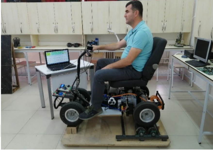
Şekil 5.35 PM senkron motorlu araç 95 kg’lık bir kullanıcıyı taşıırken yapılan bir test sırasında çekilmiş resim.
