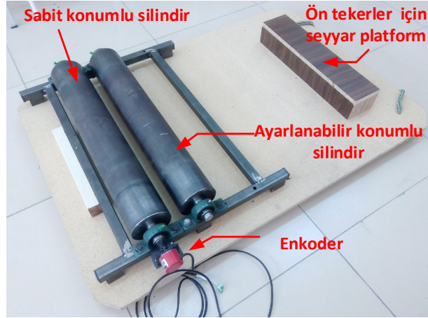
Şekil 4.1 Akülü aracın laboratuvar ortamında test edilmesi için tasarlanan test platformu.
