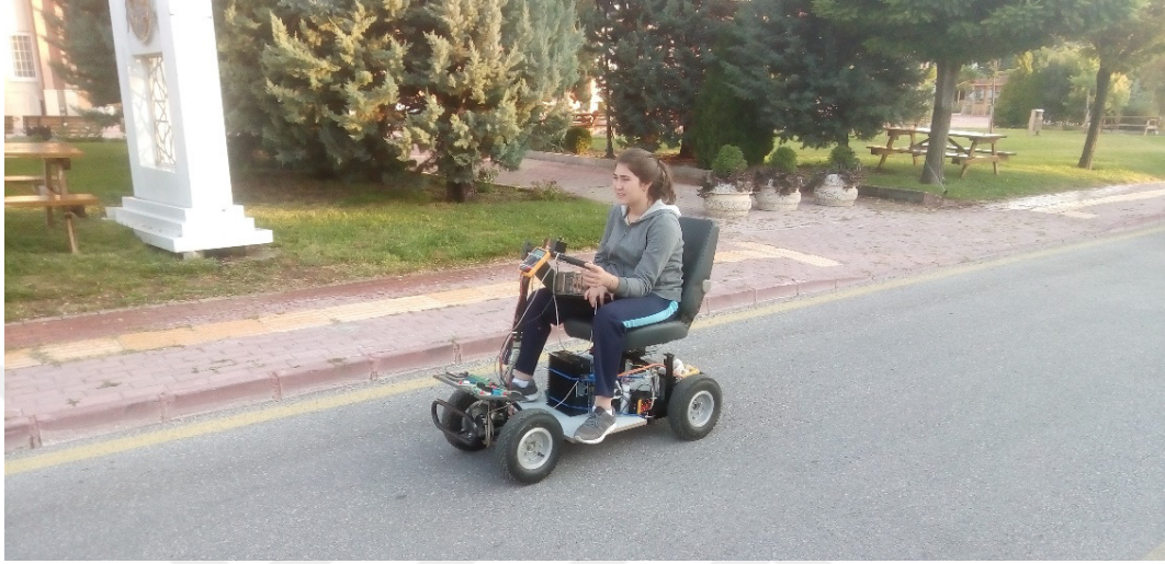
Şekil 5.39 70kg'lık kullanıcıyı taşıyan PM senkron motorlu aracın test edilmesi sırasında alınmış bir görüntü.
