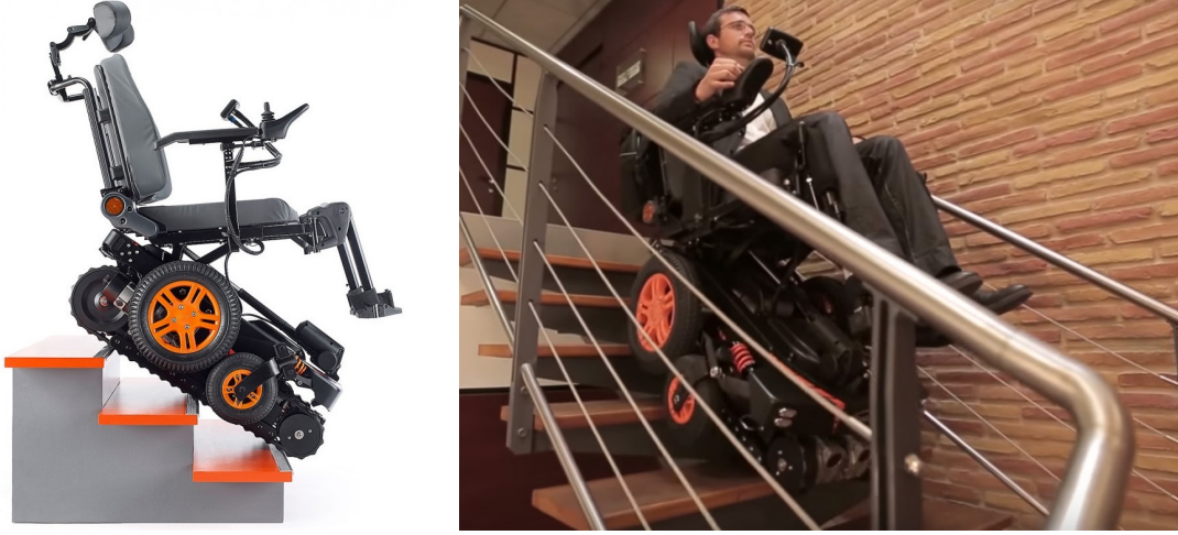
Şekil 3.7 Merdiven inip çıkabilen akülü tekerlekli sandalye.
