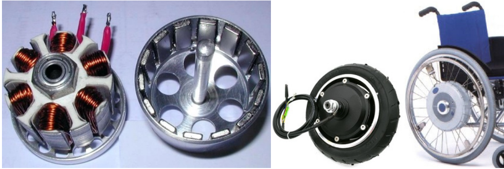
Şekil 3.12 Hub motorların iç yapısı ve farklı tekerleklere uygulanmış hâli.
