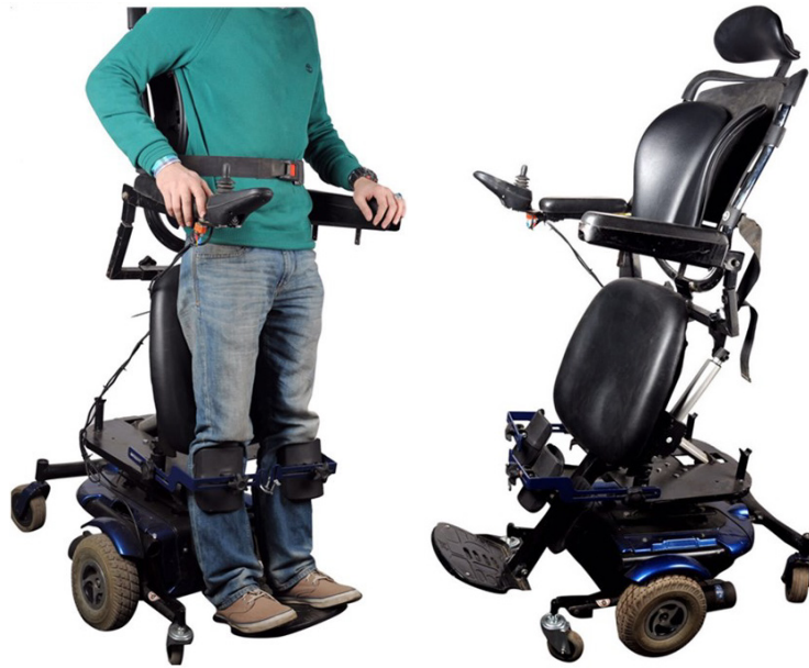
Şekil 3.5 Kullanıcısını ayağa kaldırabilen akülü tekerlekli sandalye modeli.
