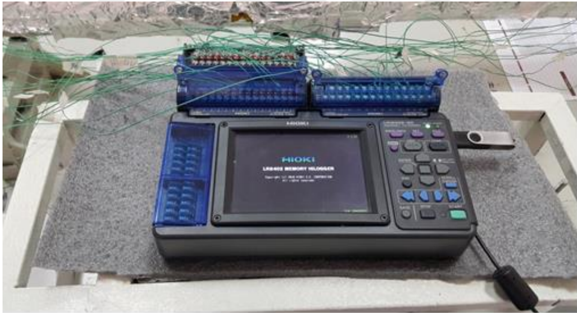
Şekil 3.7. Veri Toplayıcı ve Termokupllar
