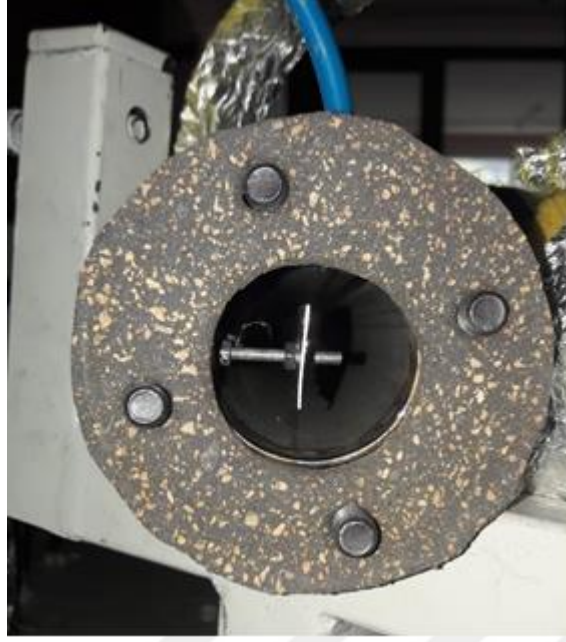
Şekil 3.12. Test borusuna dalgalı burulmuş şerit elemanın yerleştirilmesi
