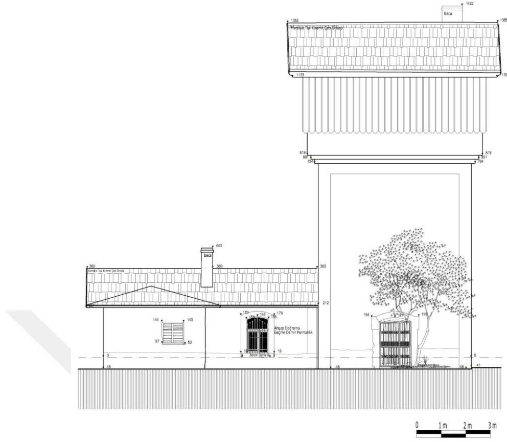
Şekil 4.84. Su Deposu Doğu Cephesi (R.Öcal,2019)
