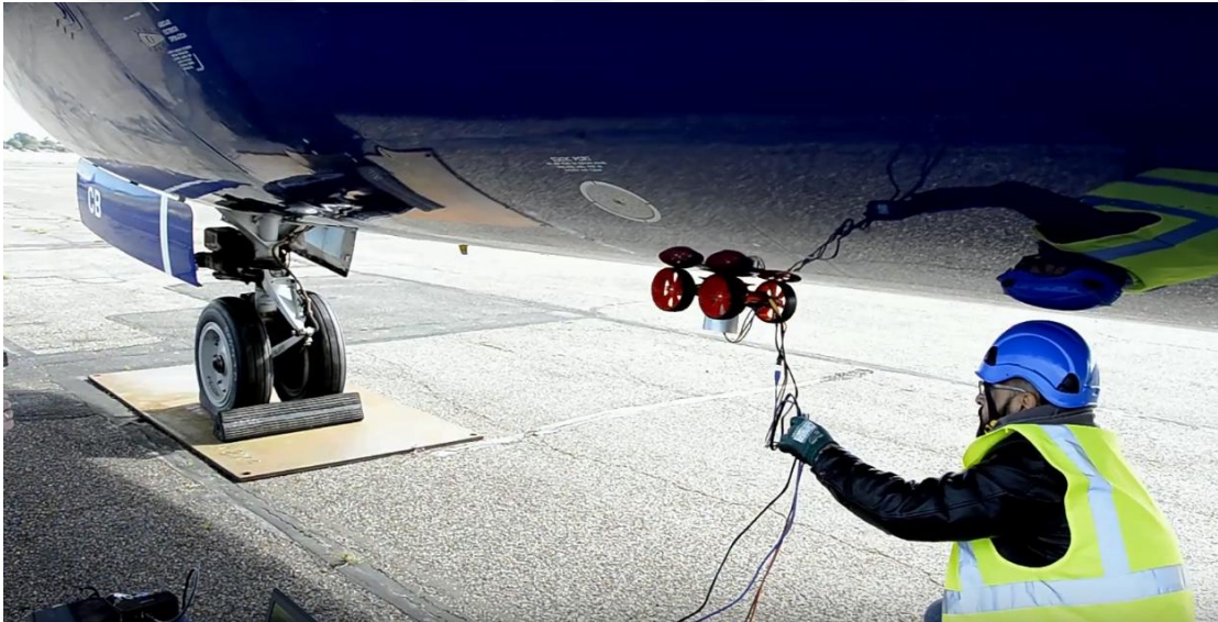
Şekil 2.10. Lulea Teknoloji Üniversitesi robotu uçak üzeri operasyonu
