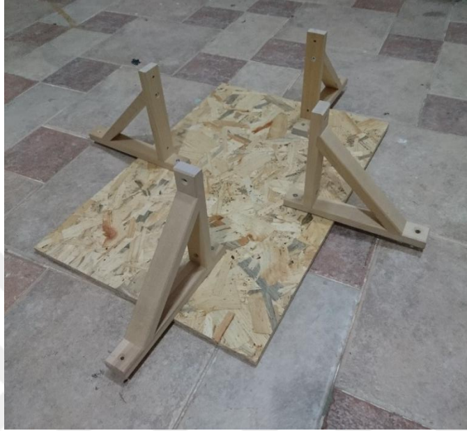
Şekil 4.5. Ölçüm eksenini dışındaki eksenlerde sistem hareketini kısıtlayan platform
