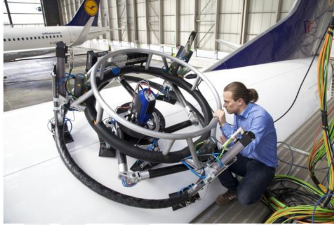
Şekil 2.6. Lufthansa Technic NDT robotu
