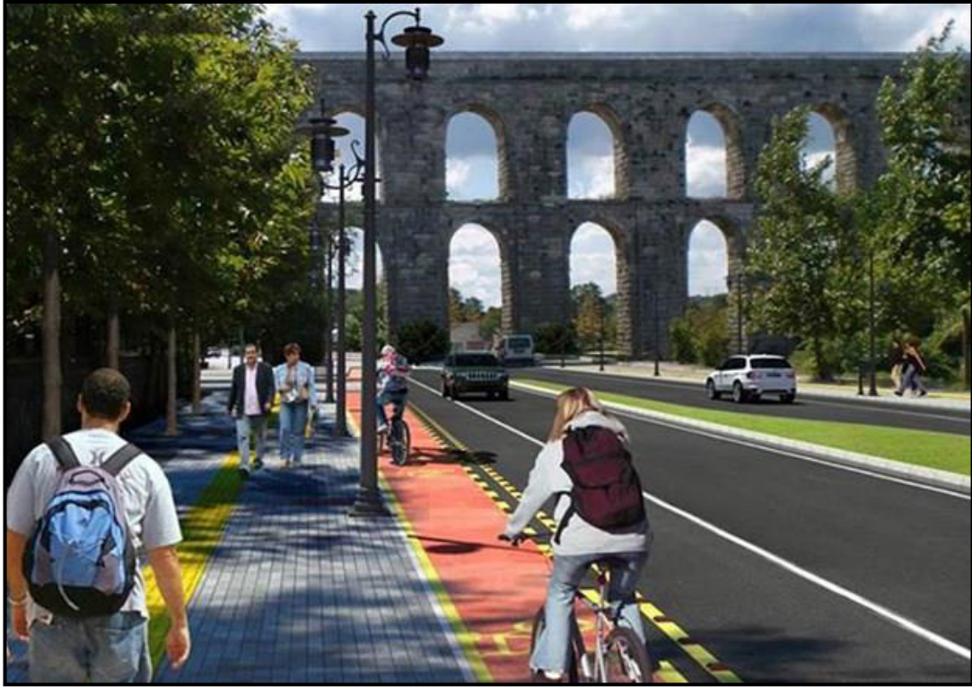
Resim 11. İstanbul'da Uygulanmış Ayırıcısız Bisiklet Yolu ve Çizgili Koruma Bandı (URL9).
