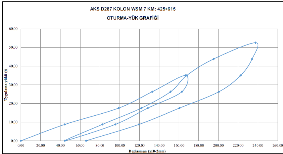
Şekil 5.32. KM 425+615 Oturma-Yük grafiği
