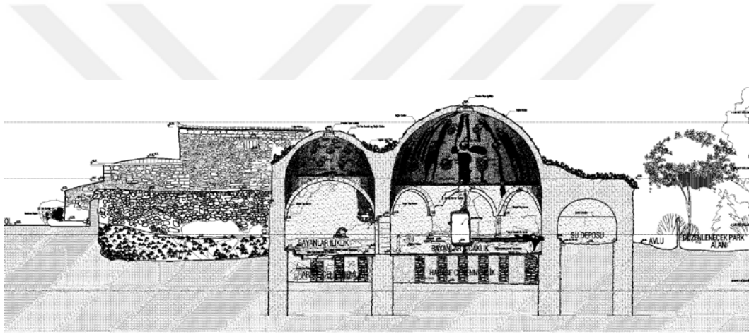
Şekil 4.103. Sille Subaşı Hamamı 4A kesiti kadınlar bölümü (Rölöve Raporu)(Turquoise Design Restoration Mimarlık, 2016b).
