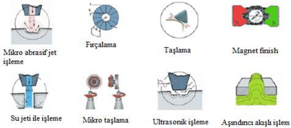
Şekil 3.32. Mekanik yöntemler; a. Mikro abrasif jet işleme; b. Fırçalama; c. Taşlama; d. Magnet finish; e. Su jeti ile işleme; f. Mikro taşlama; g. Ultrasonik işleme; h. Aşındırıcı akışlı işlem
