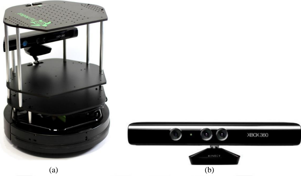
Şekil 4.3 Turtlebot 2 robotu (a) ve Kinect Kamera (b)
