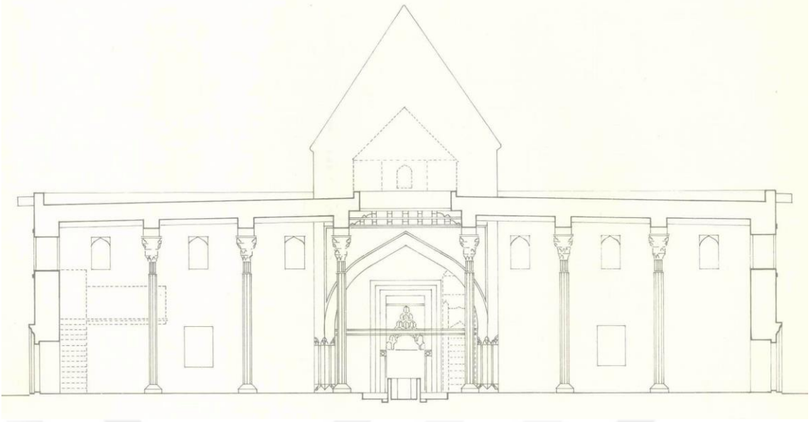
EK 4-Şekil 5. Doğu-batı istikametinden güneye bakan kesit
