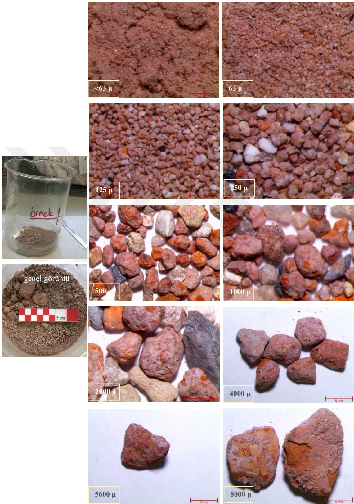
Şekil E(EK )5. 1. HMK 1 no.lu örneğin asitle muamele sonrası kalan kısmının genel görüntüsü ve agregasyon boyut dağılımı stereo mikroskop görüntüleri
