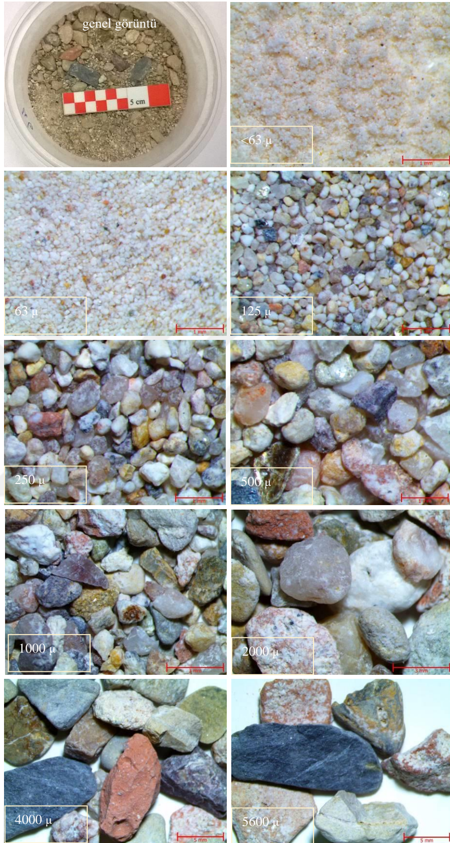
Şekil E5. 20. SMK 1 no.lu örneğin asitle muamele sonrası kalan kısmının genel görüntüsü ve agrega boyut dağılımı stereo mikroskop görüntüleri
