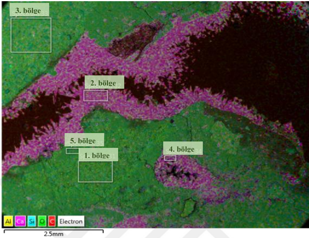
Şekil E3. 38. HMK Örnek 9, 3. alan mapping SEM görüntüsü ve EDS analizi yapılan bölgeler
