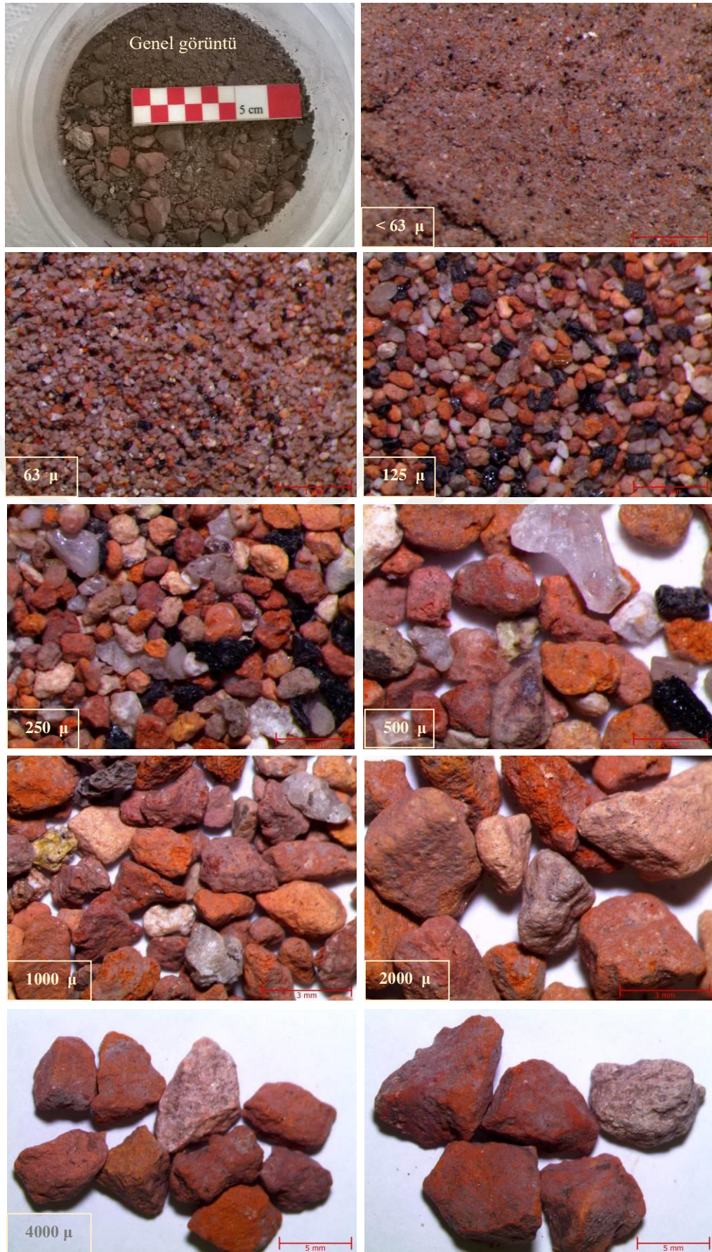
Şekil E5. 3. HMK 3 no.lu örneğin asitle muamele sonrası kalan kısmının genel görüntüsü ve agrega boyut dağılımı stereo mikroskop görüntüleri
