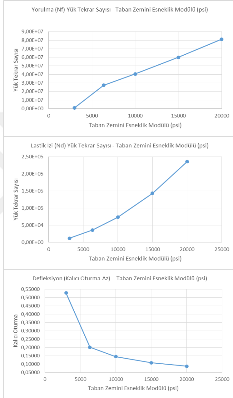
Şekil 5.21. Taban Zemini Esneklik Modülüne ( M_R ) Bağlı Olarak Lastik İzi Yük Tekrar Sayısı ( N_d ), Yorulma Yük Tekrar Sayısı ( N_f ) ve Defleksiyonun ( \Delta_z ) Değişimi
