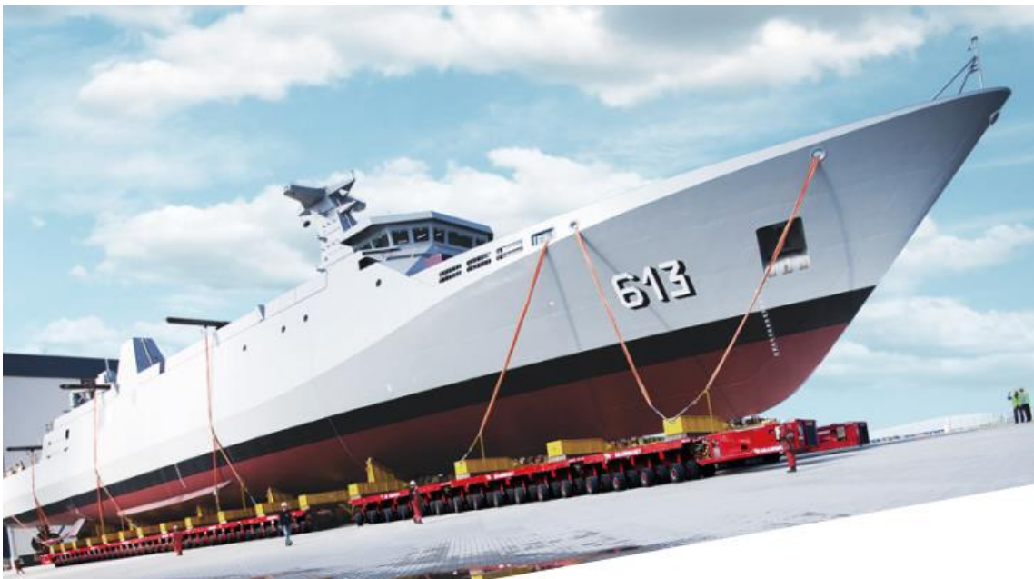
Şekil 4.1. Bir Geminin SPMT kullanılarak Karayolunda Nakledilmesi (Scheuerle, 2019)
